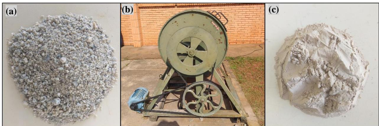
Figura 3.14 – Escória de alto forno (a) após recebimento no laboratório (b) equipamento de moagem (c) após preparação para ensaios.
