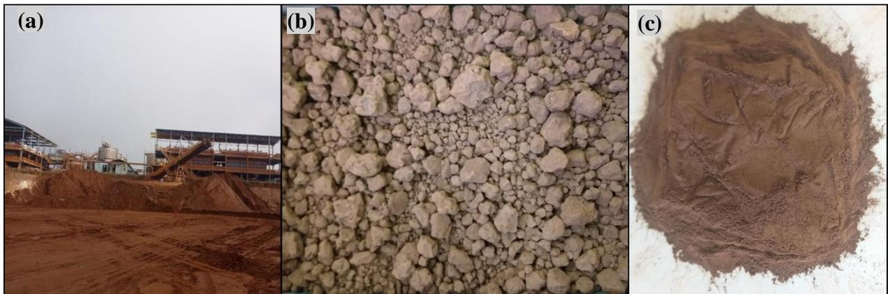
Figura 3.8 - Rejeito de minério de ferro (a) local de disposição (MIGUEL, 2022), (b) após transporte para laboratório (c) após preparação para ensaios.
