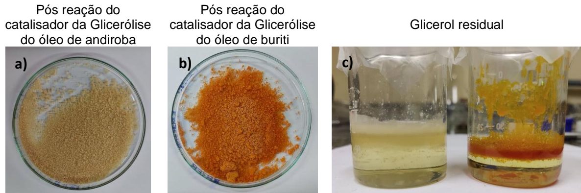
Figura 33 – Aspecto visual dos catalisadores após lavagem com t-butanol ao final das reações de glicerólise enzimática com os óleos de andiroba (a) e buriti (b), e do glicerol residual (c).
