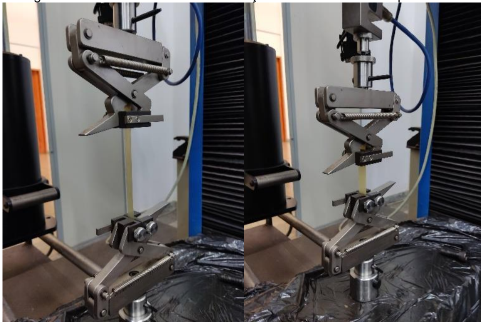
Figura 24 – Ensaio de resistência à tração realizado nos filmes poliméricos
