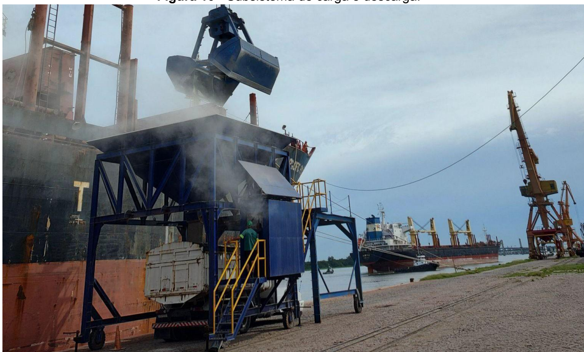
Figura 10 - Subsistema de carga e descarga.
