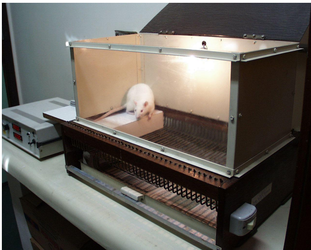
Figura 5 – Vista geral da caixa automatizada utilizada no experimento de Esquiva Inibitória.
