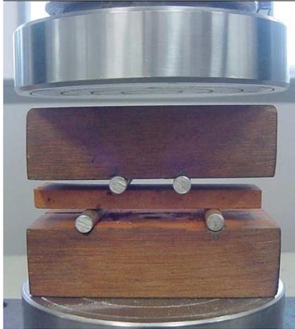
Figura F.4 - Detalhe da prensa hidráulica utilizada no corpo-de-prova submetido à flexão a quatro pontos.
