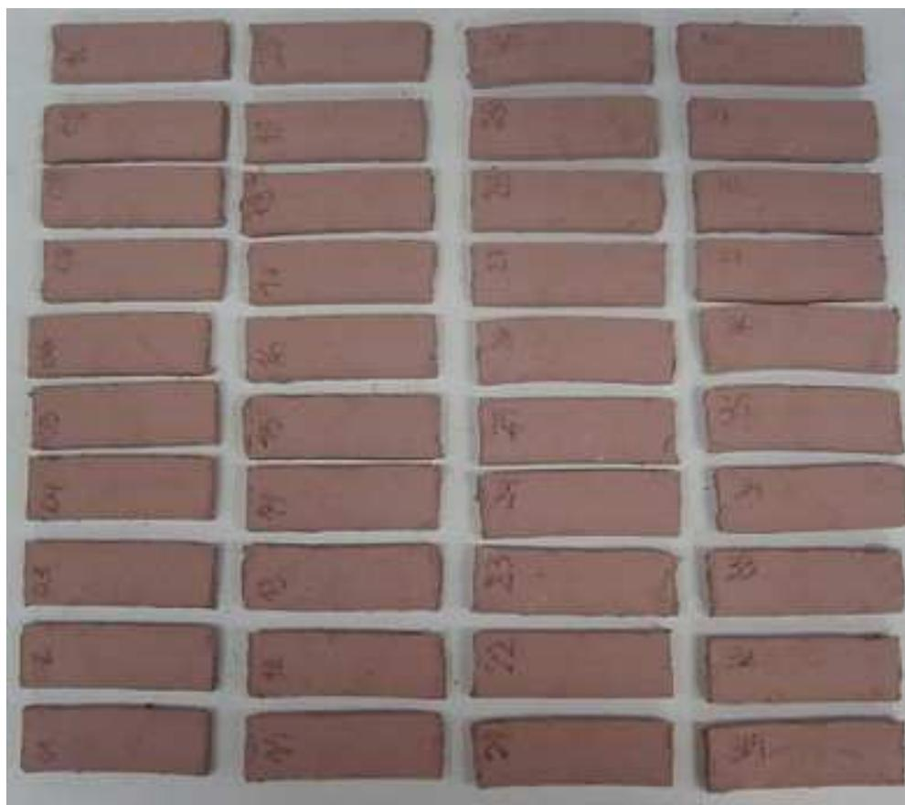
Figura 5.17 - Corpos-de-prova após extrusão.
