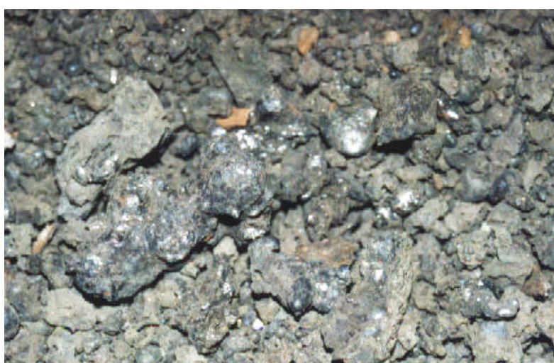
FIGURA 62 Forma dos grãos da fração metálica da amostra RB1
