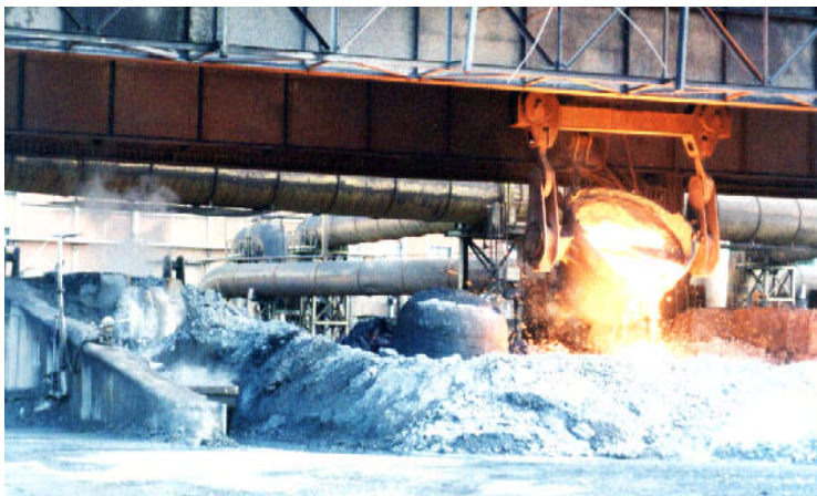
FIGURA 22 Vazamento da escória líquida restante do pote na área do pátio destinada ao resfriamento lento da escória
