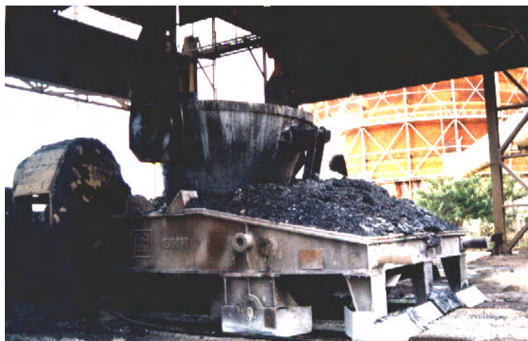
FIGURA 19 Pote de escória LD sobre o carro-guia sendo içado pela ponte rolante
