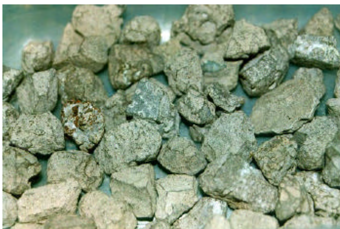
FIGURA 27 Detalhe da forma dos grãos das escórias LD de resfriamento lento
