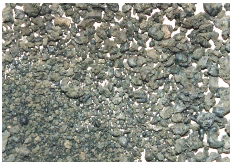
FIGURA 61 Forma dos grãos da fração não-metálica da escória granulada na usina – amostra RB1
