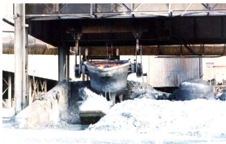
FIGURA 21 Vazamento da escória líquida na caçamba com água onde notou-se a concentração de vapores durante a granulação
