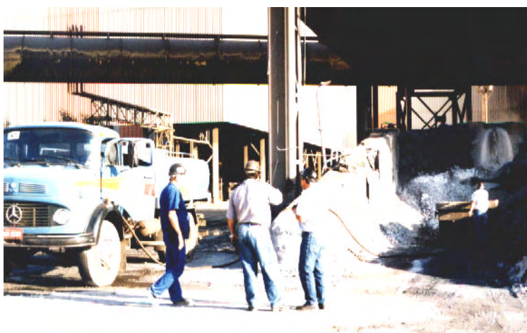
FIGURA 17 Vista da área destinada à granulação da escória LD na usina siderúrgica mostrando o caminhão pipa e a caçamba empregados na granulação
