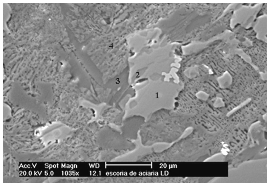
FIGURA 37 Micrografia da escória de aciaria LD resfriada lentamente - amostra RL1 - MEV por elétrons secundários - ampliação de 1035X Obs.: Os números indicados mostram os pontos submetidos à análise por EDS.
