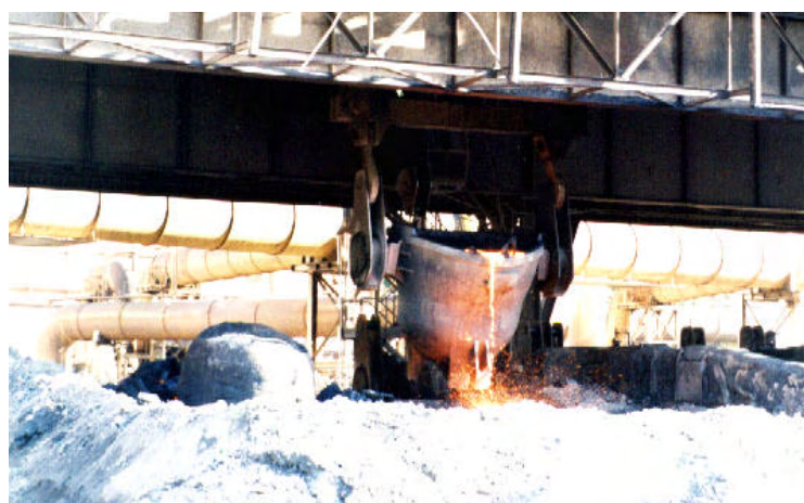
FIGURA 20 Teste de vazamento da escória líquida no pátio de resfriamento lento para verificação da quantidade de escória a ser vertida na granulação
