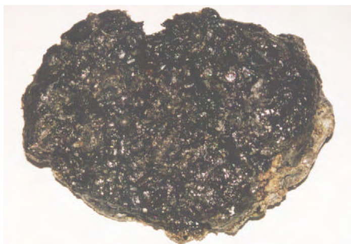
FIGURA 78 Aspecto físico da amostra RB3 após a granulação
