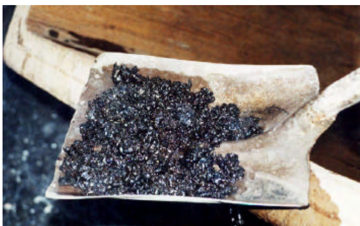
FIGURA 24 Retirada da escória granulada da caçamba com pá
