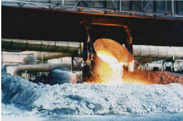
FIGURA 2 Escória de aciaria líquida sendo descartada no pátio de resfriamento
