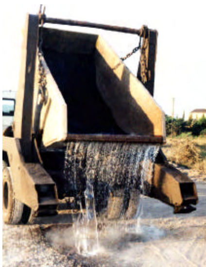
FIGURA 23 Vazamento da água da caçamba utilizada na granulação da escória LD
