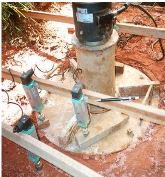
Figura 4.6 – Sistema de medição de deslocamentos
