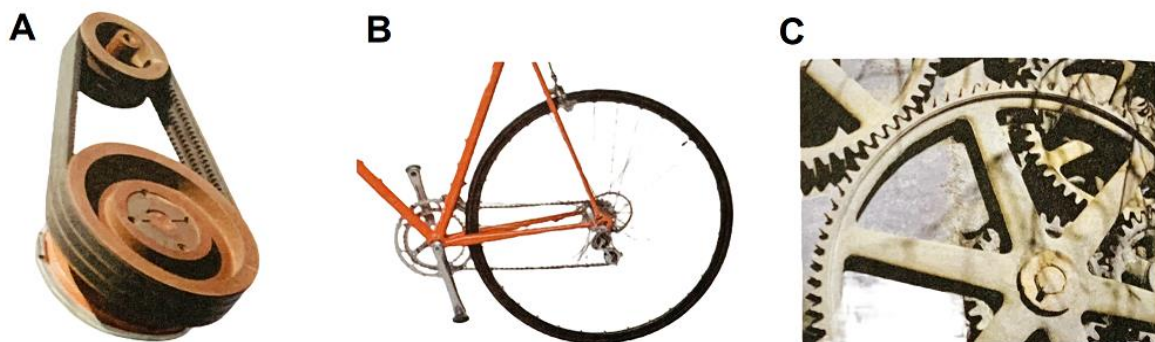
Figura 31 - Representação de transmissão de movimento circular: (A) por meio de correia; (B) por meio de corrente; (C) pelo contato direto entre engrenagens.
