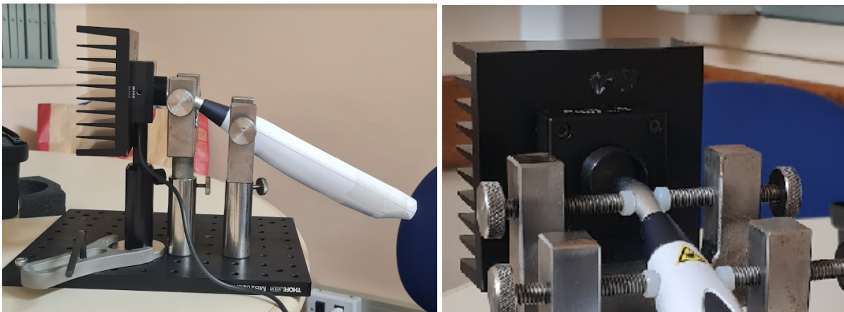
Figura 3. Estrutura projetada para fixação do laser durante a realização das medidas de potência óptica. A mesa de medidas e o suporte do sensor foram adquiridos pela instituição junto com o medidor de potência.
