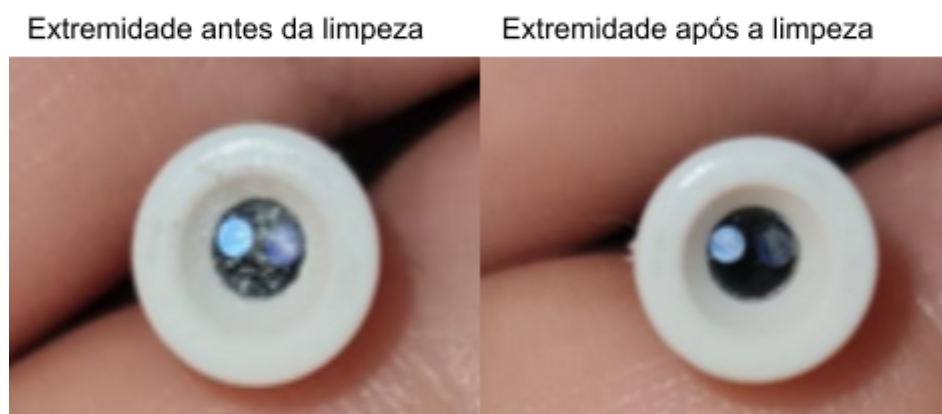
Figura 10. Imagem comparativa da ponteira do laser onde ocorre a emissão, antes e após a realização da limpeza.
