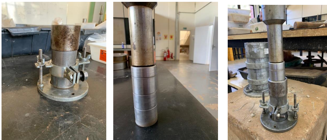
Figura 3.28 - Molde tripartido, soquete utilizado cm suas marcações e o conjunto de ambos sendo utilizados, respectivamente.
