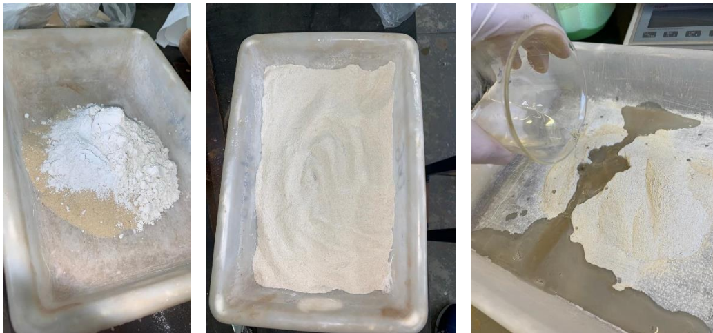
Figura 3.27 - Material seco, mistura homogênea dos materiais e mistura com solução alcalina, respectivamente.
