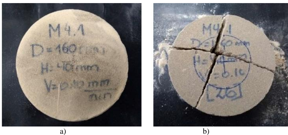
Figura 2.21 - Tipos de ruptura: (a) ruptura por puncionamento; (b) ruptura no reforço (adaptado de CABALLERO, 2019).
