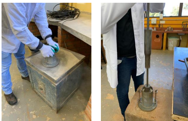
Figura 3.16 - Mesa vibratória e Proctor utilizado para compactação, respectivamente.
