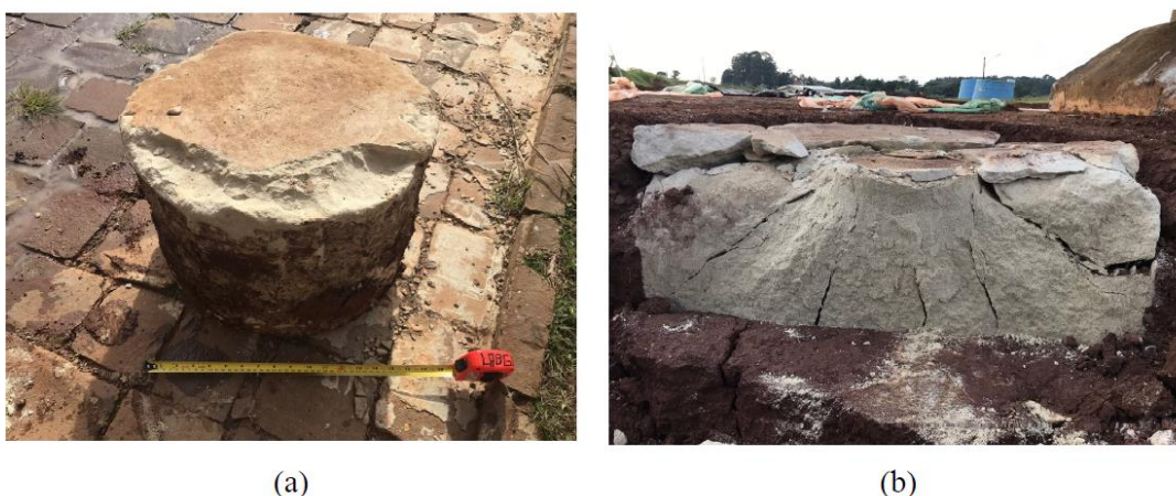
Figura 2.23 - Ruptura por puncionamento H_r/D = 1,00 e T_r/H_r = 0,25 ; (b) ruptura no reforço H_r/D = 1,00 e T_r/H_r = 1,0 . (adaptado MOREIRA (2020)).
