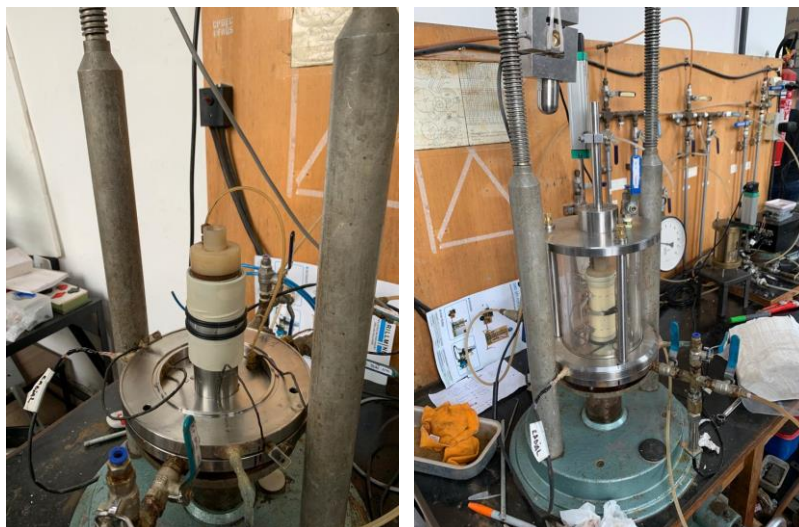
Figura 3.32 - Posicionamento da amostra e fechamento da câmara, respectivamente.
