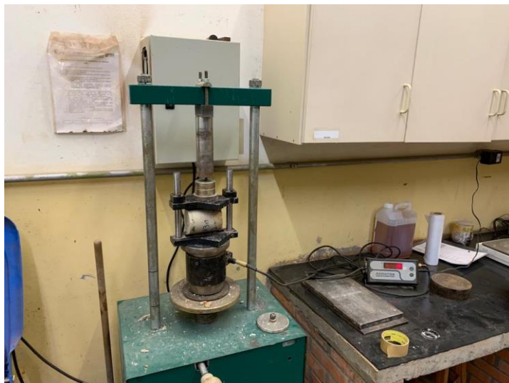
Figura 3.31 - Ensaio de compressão diametral.
