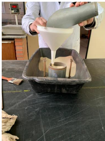
Figura 3.15 - Despejando areia com auxílio de um funil.
