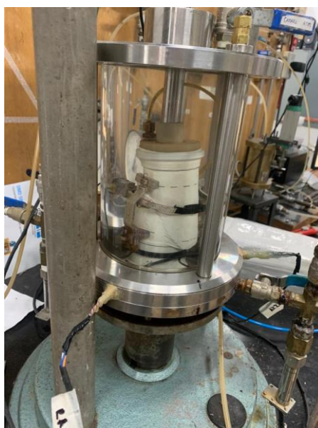
Figura 3.33 - Amostra no final do ensaio triaxial.
