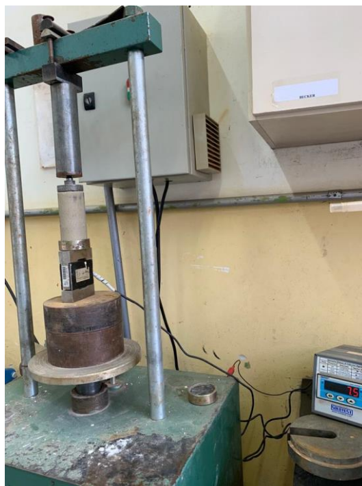
Figura 3.30 - Ensaio de compressão simples.
