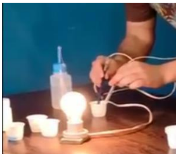
Figura 22- Teste da condutividade elétrica utilizando materiais alternativos
