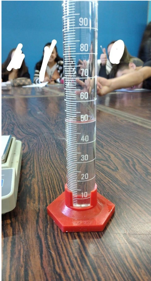
Figura 17- Adição de 50 mL de líquido na proveta para aferição do volume da amostra de mineral.
