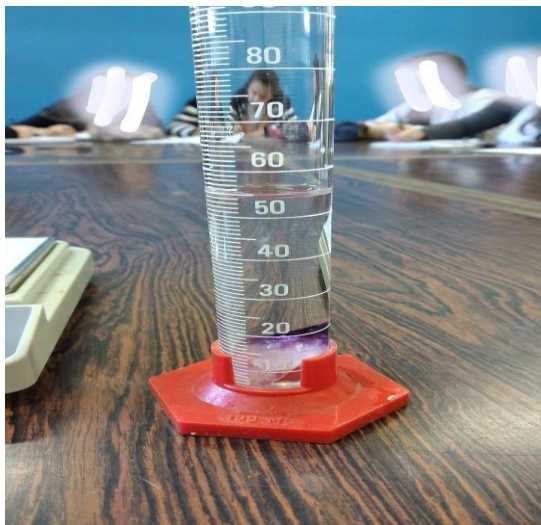
Figura 18- Volume final de 55 mL de água deslocado na proveta após adição da amostra de mineral.
