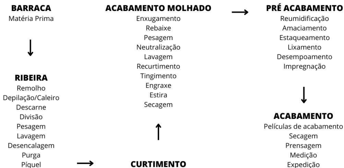
Figura 1 - Fluxograma processamento do couro
