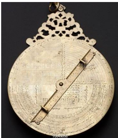
Figura 4- Astrolábio planisférico islâmico (1666)
