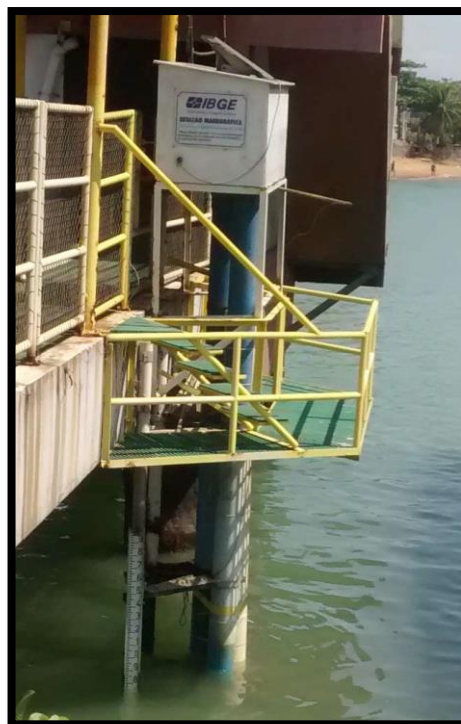
Figura 54 – Estação maregráfica de Macaé-RJ
