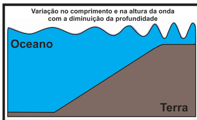
Figura 43 – Esquema mostrando a variação do comprimento e da altura da onda ao encontrar regiões mais rasas.
