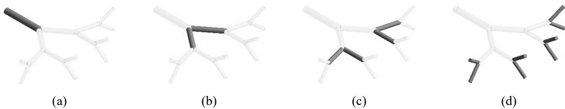
Figura 4.2 - Representação esquemática de igual volume dos tubos em cada nível de ramificação: (a) nível 0, (b) nível 1, (c) nível 2 e (d) nível 3
