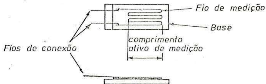
Fig. D2- Forma esquemática de um tipo de extensômetro.
