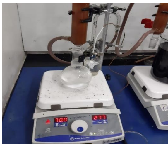
Figura 3.8 - Policondensação do MK (precursor M2)
