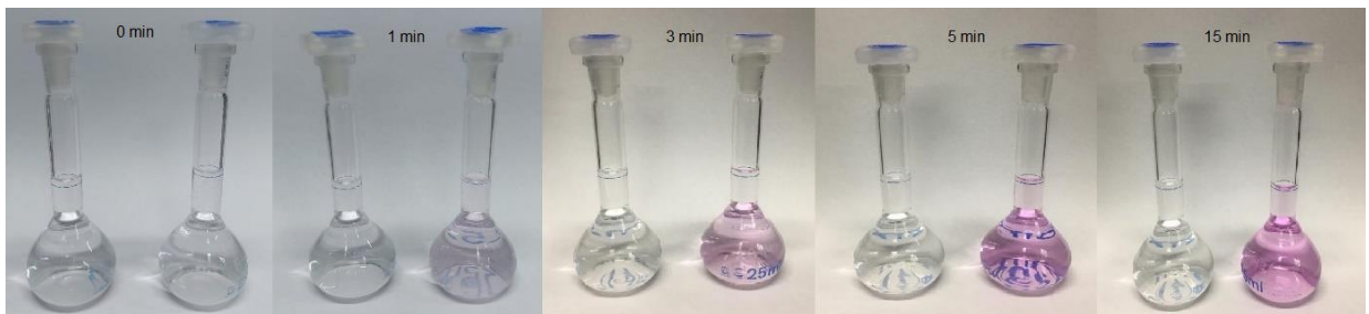
Figura 16 – Reação do Cr(VI) com a difenilcarbizada nos tempos de 0, 1, 3, 5 e 15 min
