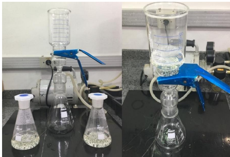
Figura 7 – Filtração a vácuo em membrana filtrante após etapa de extração
