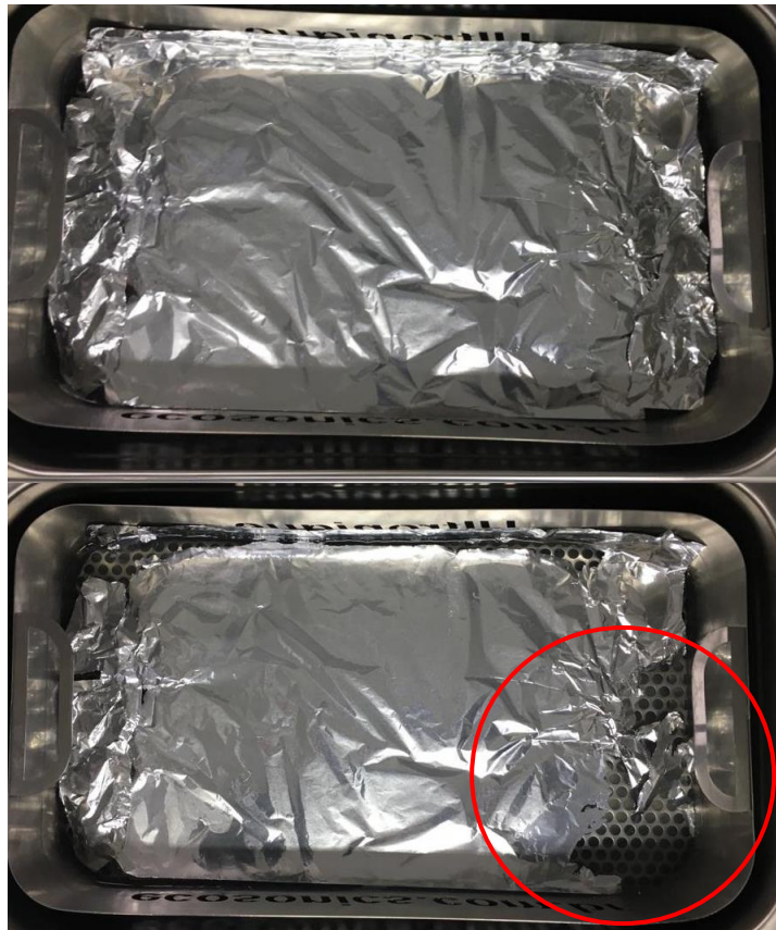
Figura 12 – Teste com folha de alumínio antes e após uso do ultrassom para identificar área de maior incidência do ultrassom
