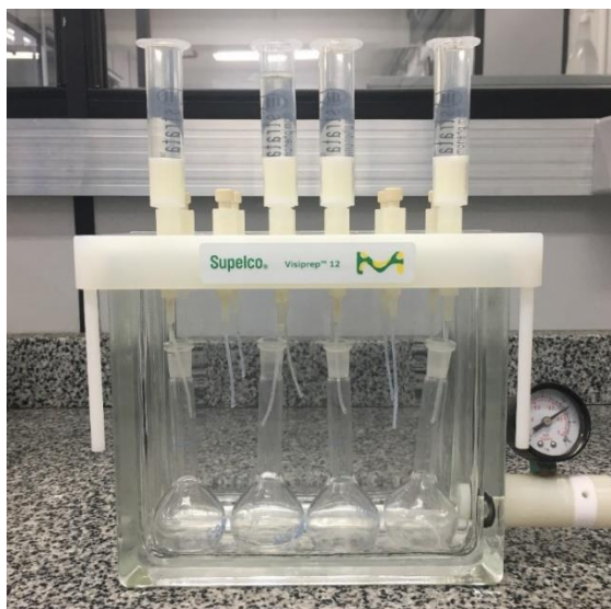
Figura 10 – Etapa de retirada de cor com dispositivo de vácuo
