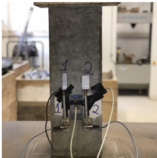
Figura 26 - Pilar com sensores fixados
