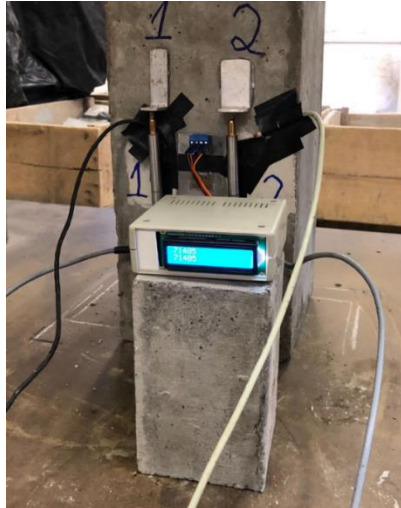
Figura 54 - Placa com extensômetros ligada ao dispositivo de leitura I
