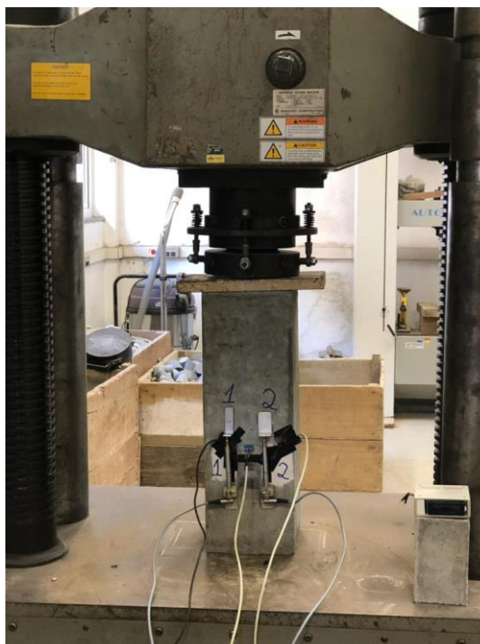
Figura 52 - Pilar com sensores ligados ao sistema de leitura QuantumX MX840B
