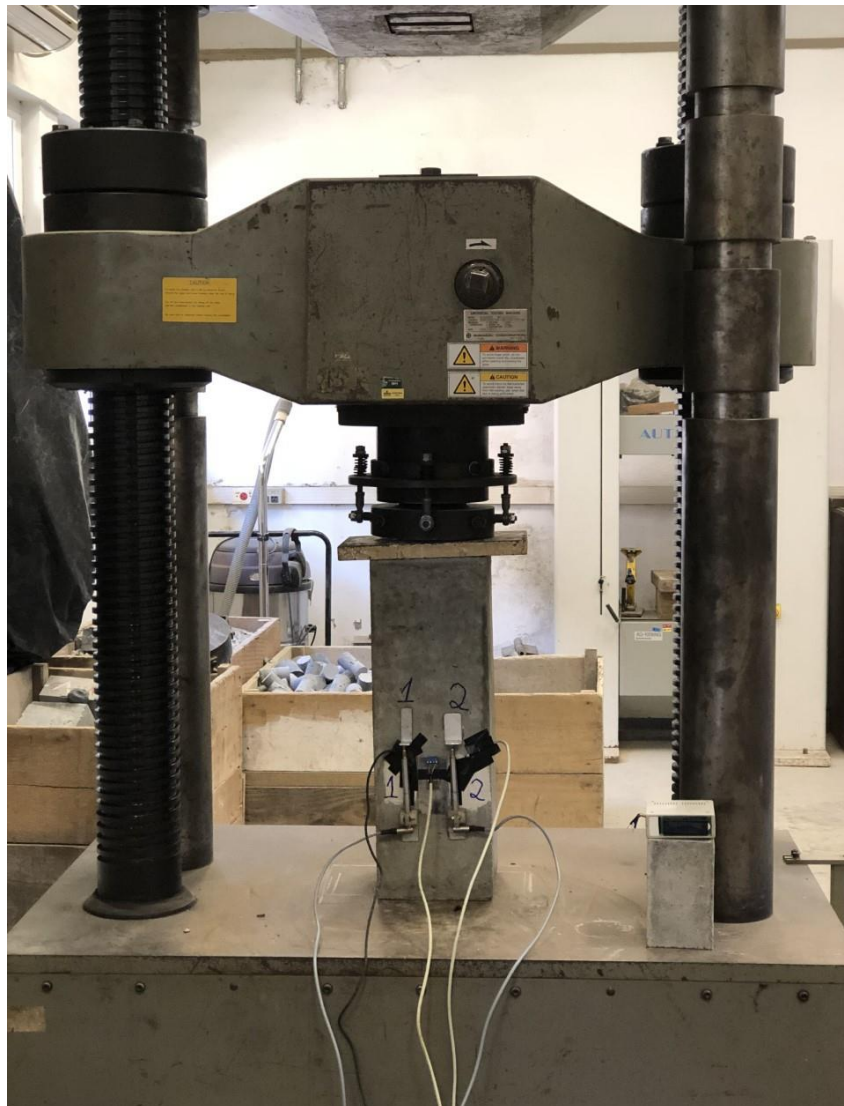
Figura 27 - Pilar com sensores ligados ao sistema de leitura QuantumX MX840B
