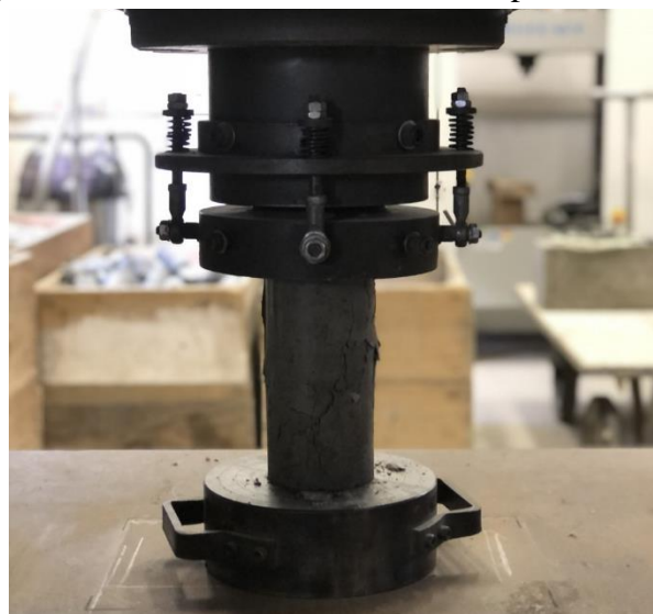
Figura 23 - Ensaio de resistência à compressão do CP
