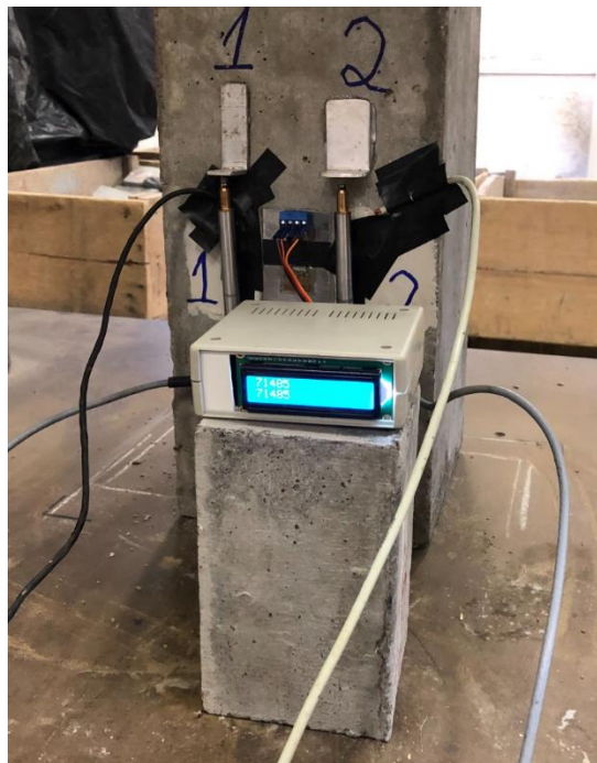
Figura 28 - Placa com extensômetros ligada ao dispositivo de leitura I
