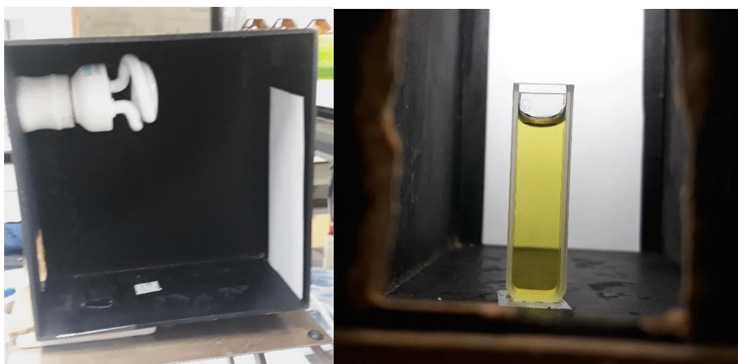
Figura 11 – Vista lateral da caixa preta (à esq.) e amostra vista através do orifício da caixa (à dir.)
