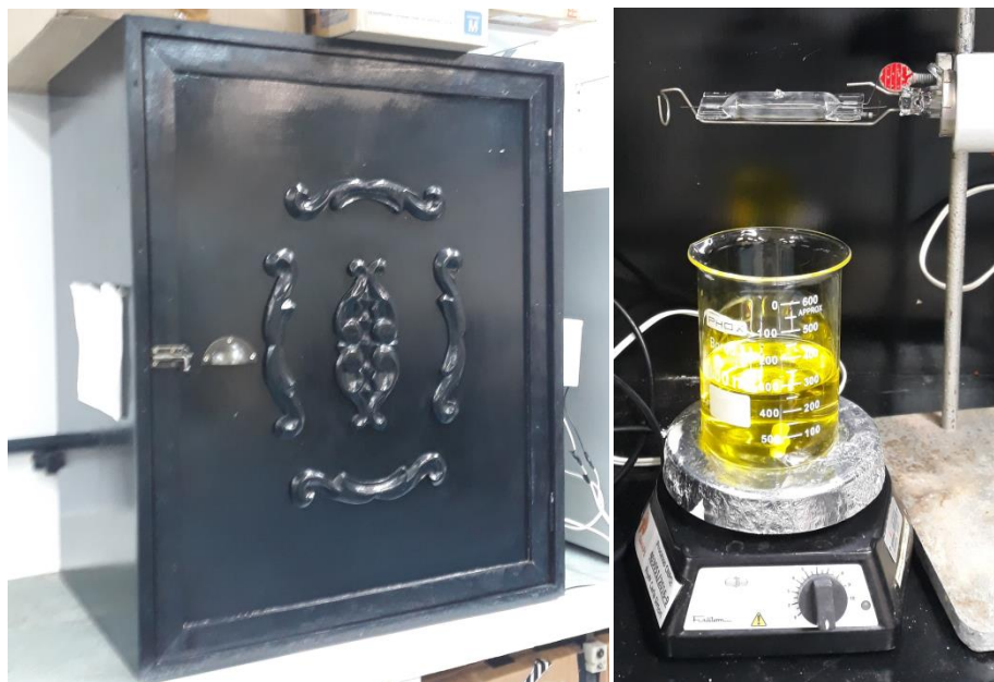
Figura 8 – Câmara escura (à esq.); posicionamento da amostra e da lâmpada de Hg na câmara escura (à dir.)
