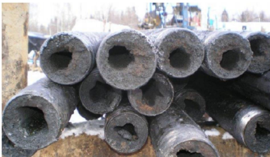
Figura 2.5: Depósito de asfaltenos em tubulações de petróleo.
