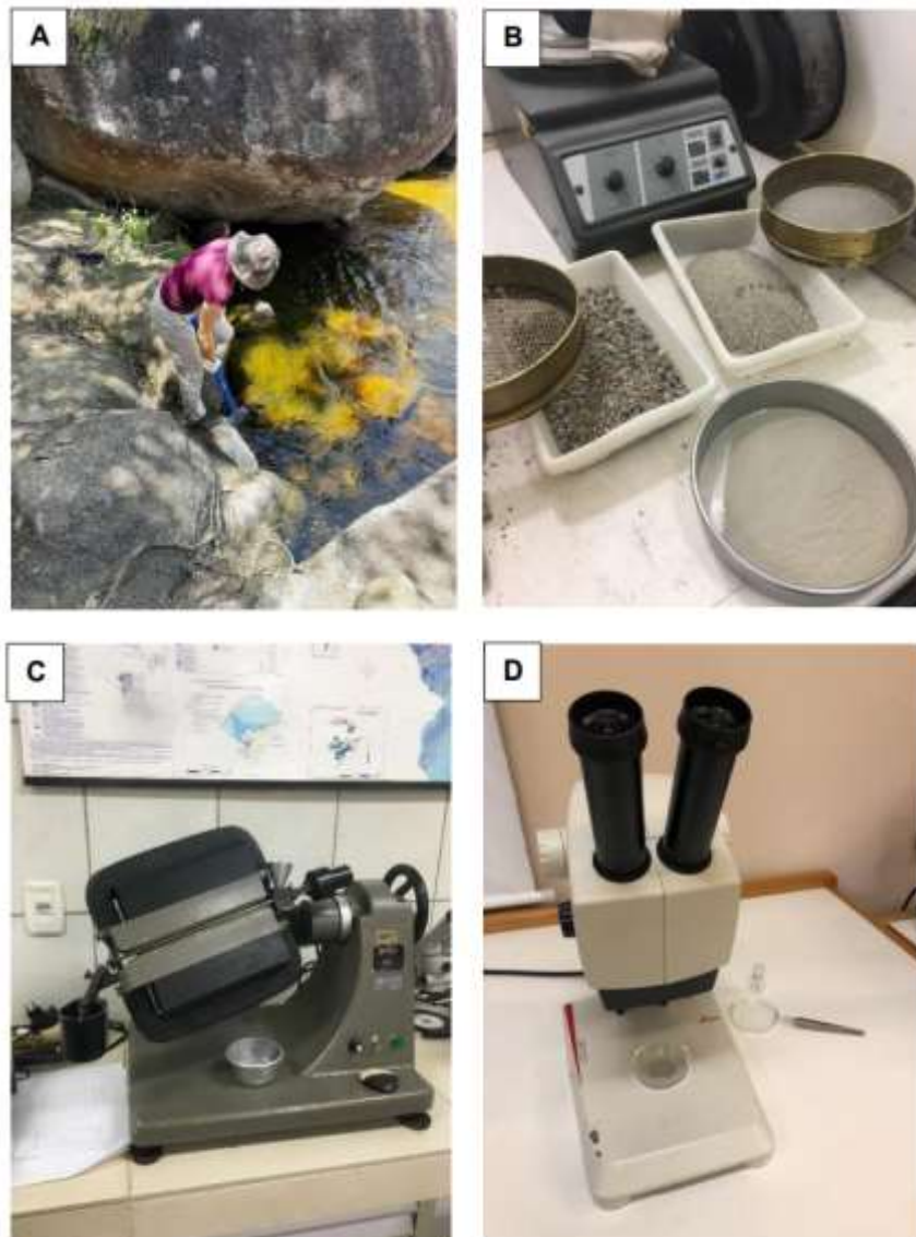
Figura 9. Fotos de etapas do processamento de amostras para análises de termocronologia de baixa temperatura: A) Coleta de amostras em campo; B) Separação mineral com peneira; C) Separação magnética com Frantz; D) Catação manual com pinça na lupa. Fonte: Fotos registradas pela autora (2022).
