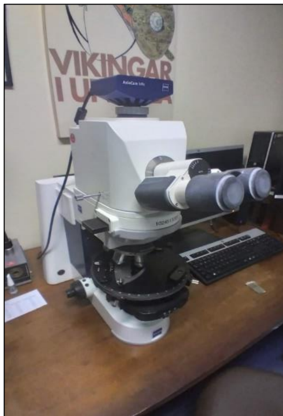
Figura 8: Microscópio Zeiss Imager A2 com câmera Zeiss AxioCam MRc acoplada para posterior manipulação das imagens no software Zen . Fonte: do autor.
