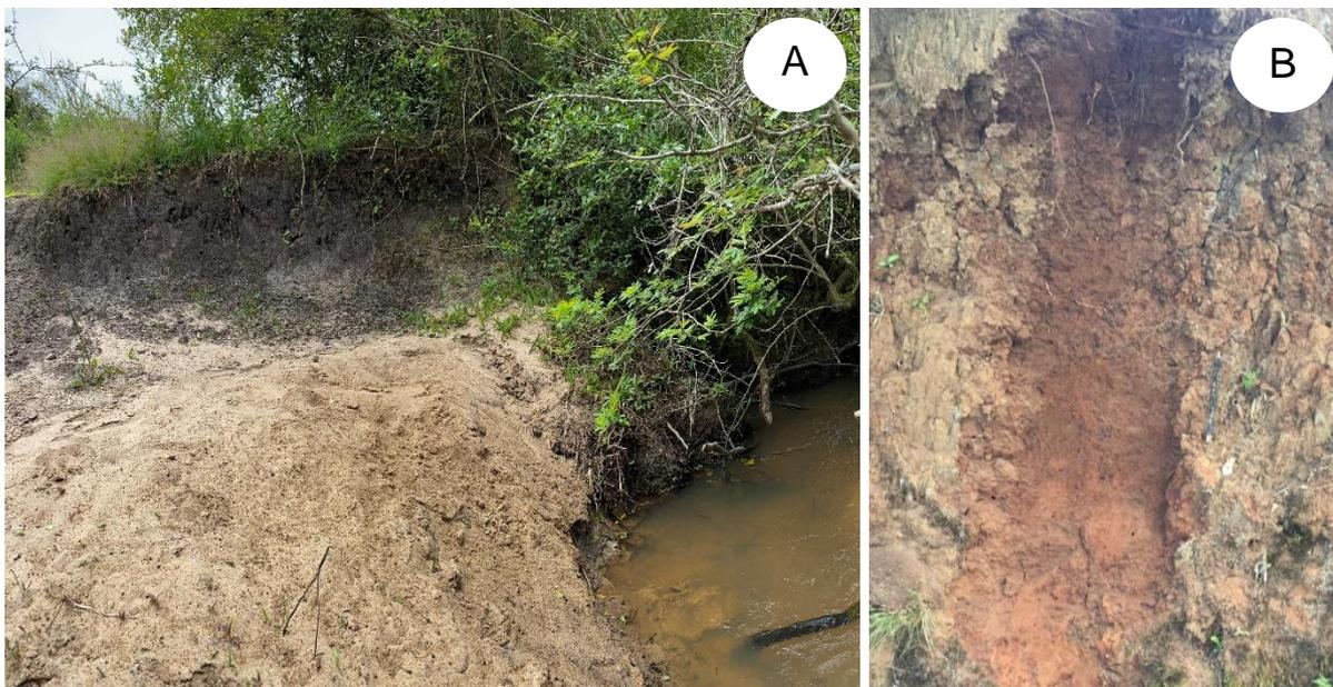
Os locais da planície aluvial com variação de perfil progressiva evidenciaram que a superfície é formada por uma camada arenosa com elevada concentração de argila e matéria orgânica (Fotografia 5; A). A base é composta por um horizonte de solo arenoso.
