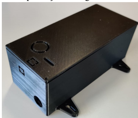
Figura 5.3: Caixa de acondicionamento feita em impressão 3d para substituir a confecção por terceiros e reduzir custos. Reprodução da Figura B.4
