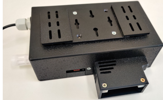
(b) Placa para fixação permanente na parede e engate na caixa e duto de ar para aquecimento embaixo.
