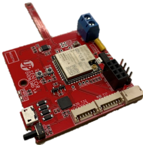
Figura A.10: Placa de circuito impresso em sua última versão modificada, agora com o sensor de umidade e temperatura integrado e preso a um apêndice distante do restante da placa, com muita área de troca de calor.
