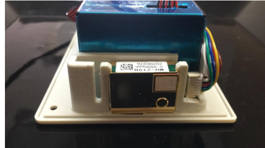
(b) Fixação através de pressão, sem o uso de parafusos. Dourado é o sensor MH-Z19 e azul o PMS5003.
