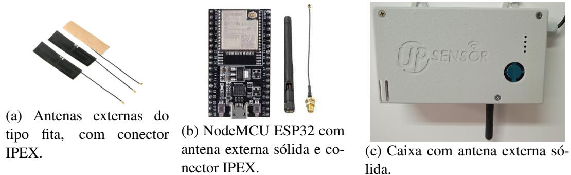
Figura 4.25: Tipos de antena de comunicação não impressas na ESP32 podem ser adicionadas para melhorar a comunicação Wi-Fi com a internet. Antenas do tipo fita (a), sólidas (b) e com uma montagem em uma caixa (c).
