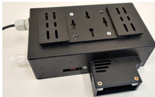
(b) Placa para fixação permanente na parede e engate na caixa e duto de ar para aquecimento embaixo.
