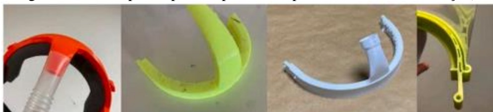
Figura 28: Protótipos impressos para o componente da faixa da cabeça ( headband )
