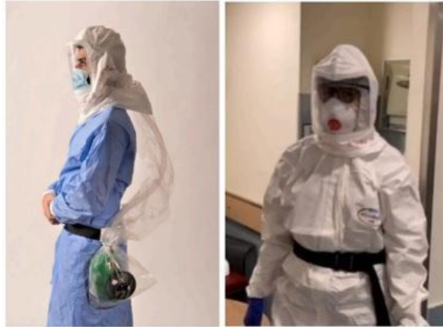
Figura 29: Sistema/Design do “ Air-Shade ” (imagem à esquerda) e profissional testando o sistema (imagem à direita).
