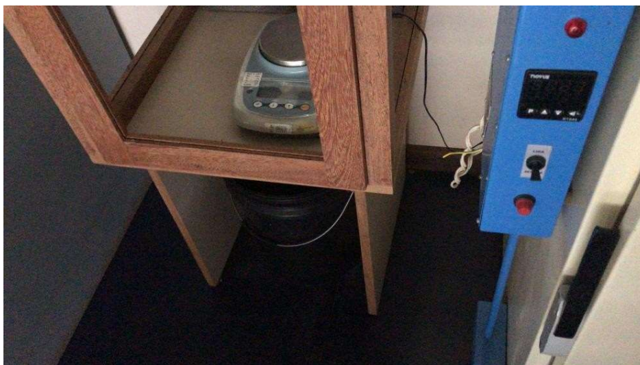
Figura 11 - Balança com pesagem por baixo, cesto cilíndrico e tanque com água utilizada para determinação dos índices físicos.
