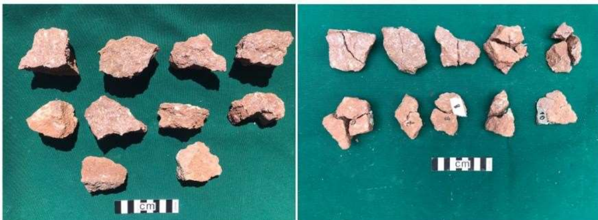
Figura 31 - Rubbly antes do ensaio de carga pontual (esquerda) e após o rompimento (direita).
