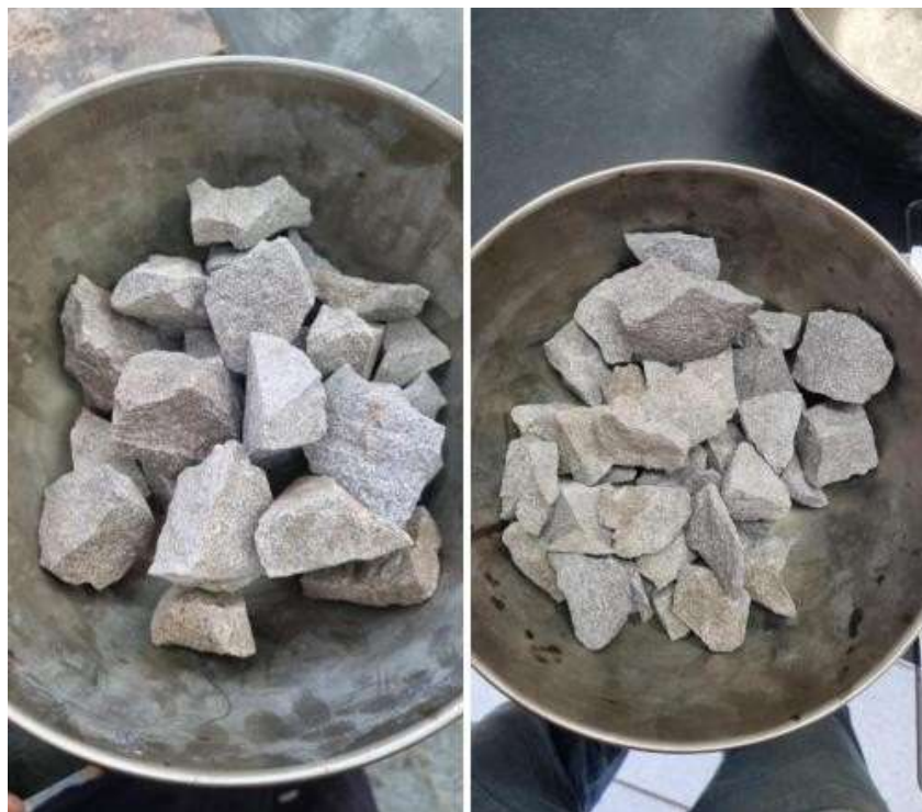
Figura 33 - Riodacito após o ensaio de sanidade com sulfato de sódio, mostrando baixíssima degradação.
