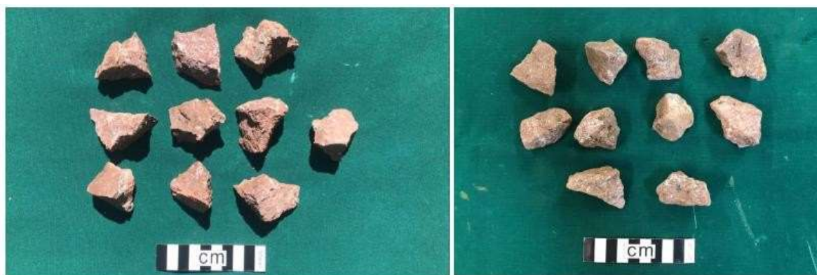
Figura 32 - Rubbly antes do ensaio de durabilidade a úmido (esquerda) e após a realização do 5º ciclo (direita).
