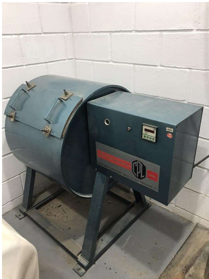
Figura 12 - Tambor utilizado para o ensaio de abrasão “Los Angeles”.
