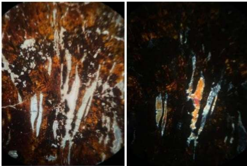
Figura 29 - Amígdalas com a presença de zeólitas e calcedônia. Nícois descruzados a esquerda e nícois cruzados a direita.
