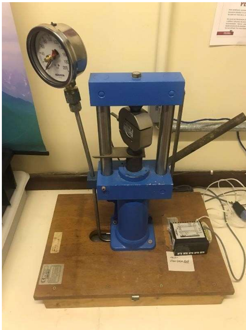
Figura 16 - Equipamento utilizado para o ensaio de carga pontual.
