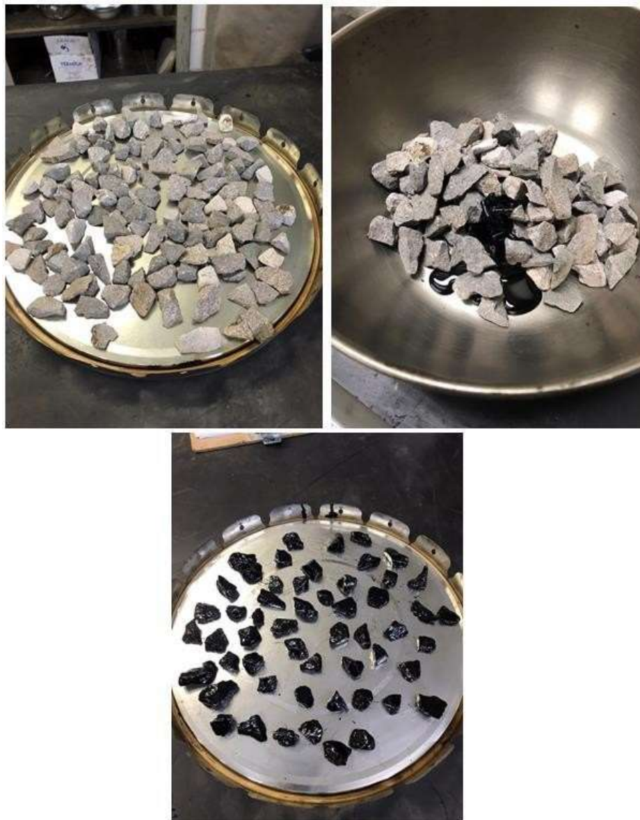
Figura 13 - Preparação das amostras para a realização do ensaio, antes de colocar dentro do frasco de vidro com água destilada e ir a estufa.
