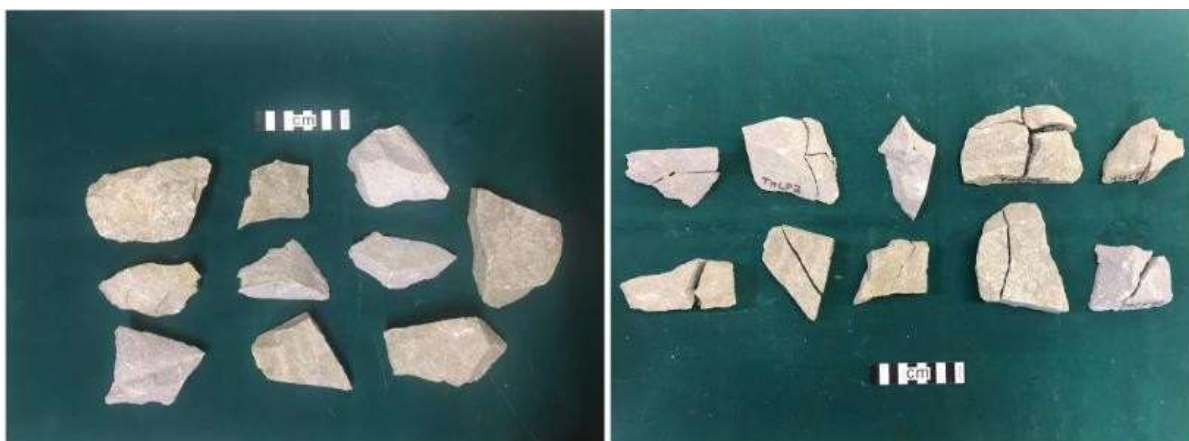
Figura 30 - Riodacito antes do ensaio de carga pontual (esquerda) e após o rompimento (direita).
