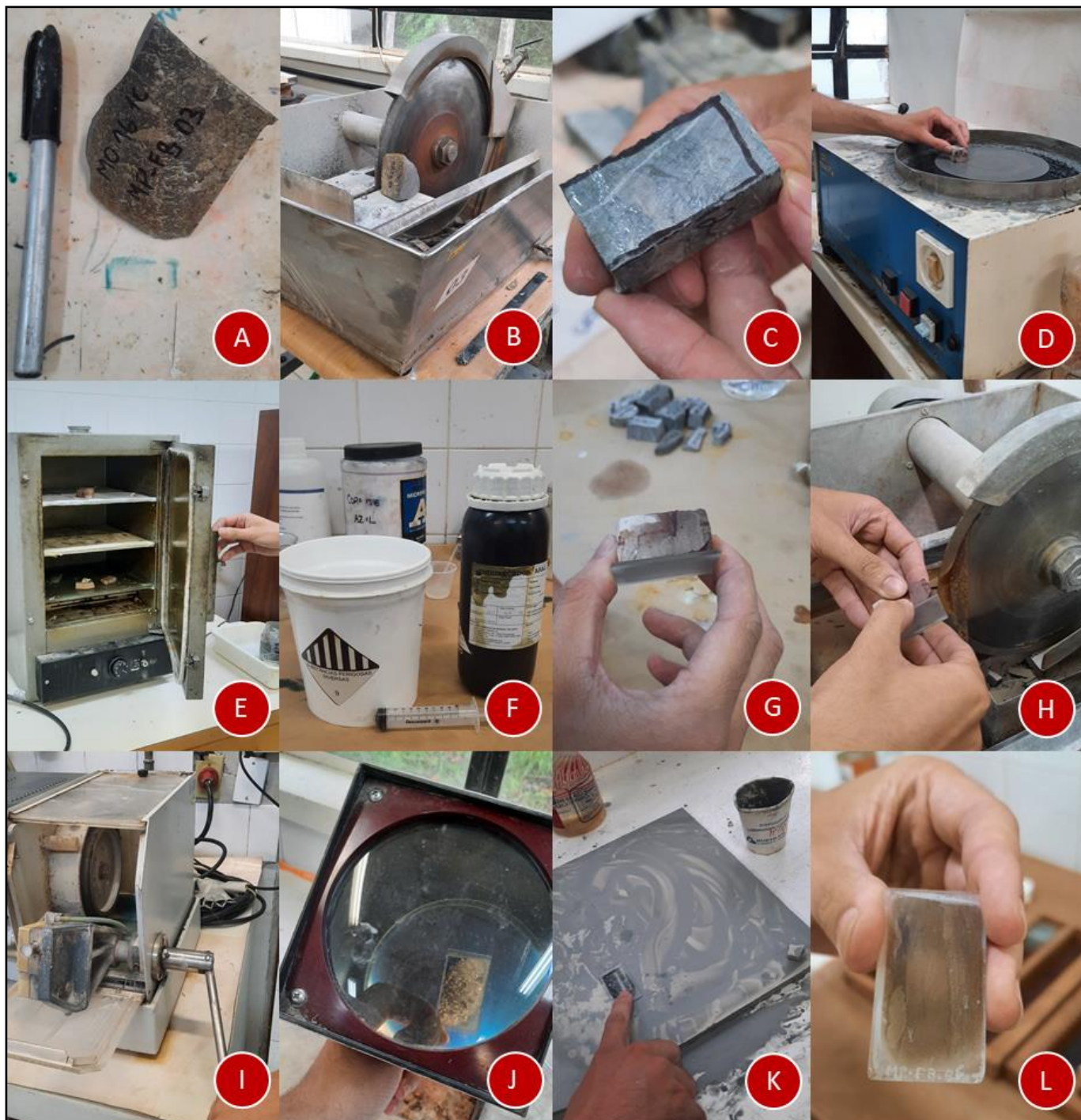
Figura 13. Etapas de preparação de lâmina delgada. A) Amostra a ser confeccionada; B) Primeira serra diamantada; C) Amostra após o corte, ainda com as ranhuras; D) Abrasivo de 320; E) Estufa; F) Resina à direita e endurecedor à esquerda; G) Amostra colada na lâmina de vidro laboratorial; H) Segunda serra diamantada; I) Serra mecanizada; J) Polarizadora; K) Abrasivo de 1000; L) Lâmina delgada pronta.
