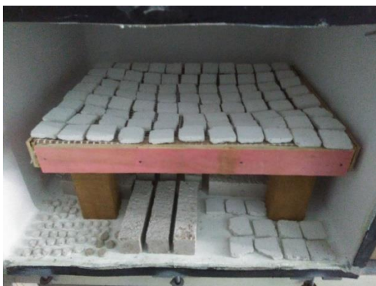
Figura 77 – Amostras disposta em câmara de carbonatação
