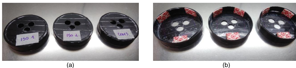
Figura 86 – Gabarito para medição com espectrofotômetro: a) parte superior para cada uma das condições de inóculo; b) parte inferior com anteparo para fixação das amostras
