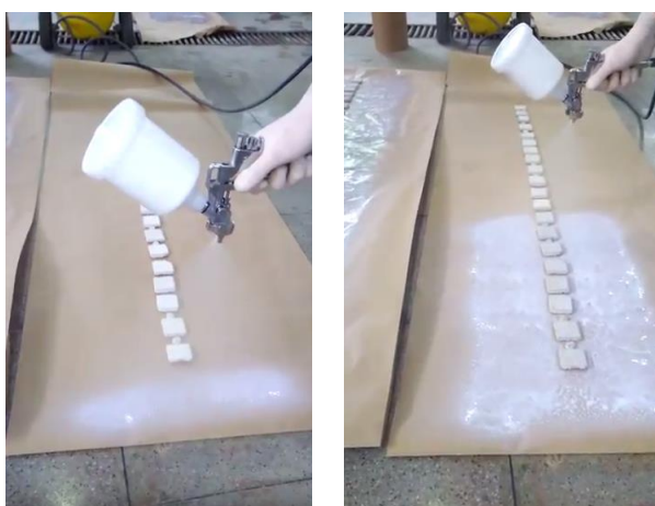
Figura 79 – Aplicação do fotocatalisador nas amostras
