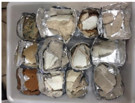
Figura 31 – Amostras dispostas em recipiente para determinação do teor de umidade
