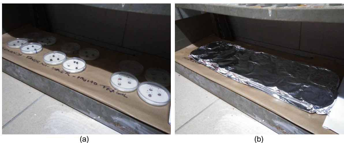
Figura 67 – Amostras dispostas em câmara para execução de ensaio na condição de escuro: a) amostras dispostas para execução do ensaio; b) amostras cobertas durante a execução do ensaio
