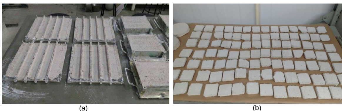
Figura 76 – Moldagem das amostras de argamassa: a) amostras em fôrma acrílica e moldadas em corpos de prova 4x4x16cm para caracterização no estado endurecido; b) amostras após desmoldagem e em cura na câmara climatizada
