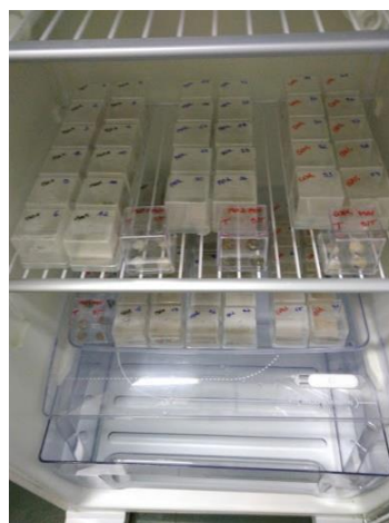
Figura 84 – Amostras inoculadas em aclimação na BOD
