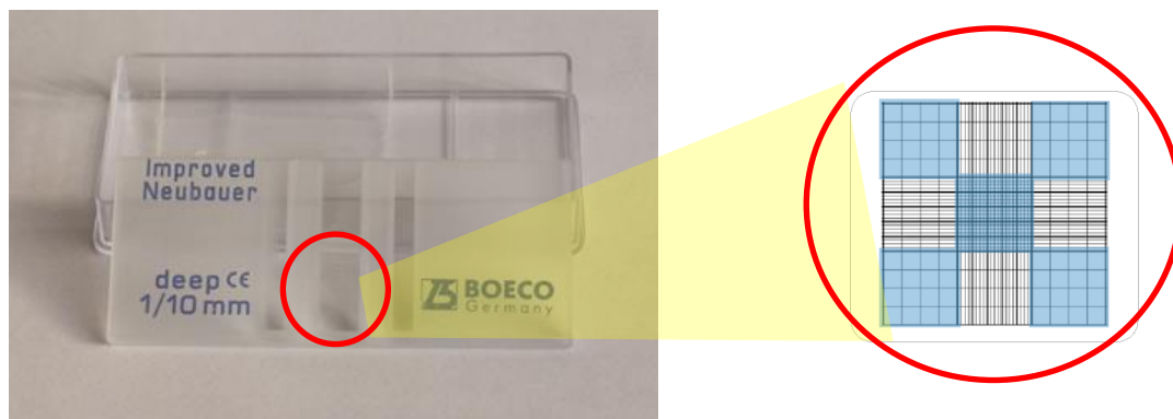
Figura 71 – Câmara de Neubauer e área de contagem considerada na câmara
