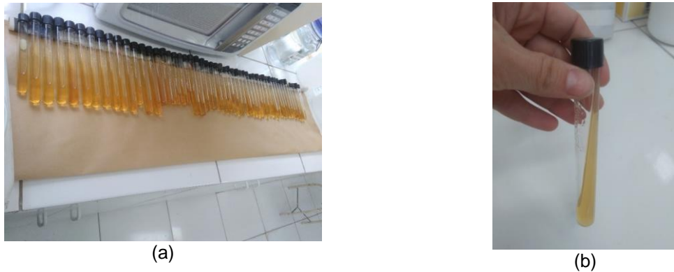
Figura 69 – Preparo de meio nutricional para suspensão de esporos: a) meio em processo de solidificação inclinada na bancada; b) meio pronto para inóculo do isolado
