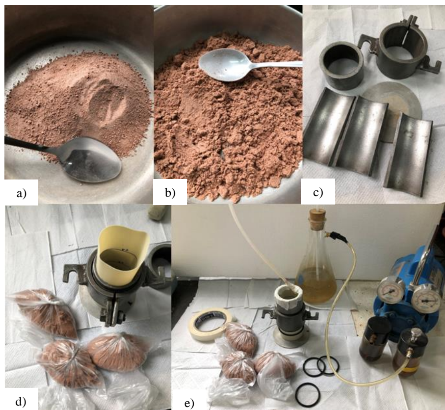
Figura 62 – Preparação para moldagem: a) rejeito de ouro seco, b) rejeito de ouro com adição de 17% de teor de umidade, c) molde tripartido adotado, d) separação das camadas e colocação da membrana no molde e e) aplicação de vácuo entre membrana e molde.
