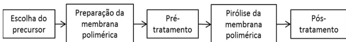
Figura 3: Etapas do processo de produção de uma membrana de carbono. Fonte: elaborada pelo autor.
