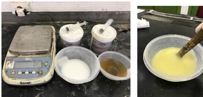
Figura 45 – Preparação da resina epóxi de aplicação em manta de fibra de carbono: (a) pesagens dos componentes A e B fracionados; (b) homogeneização manual dos componentes
