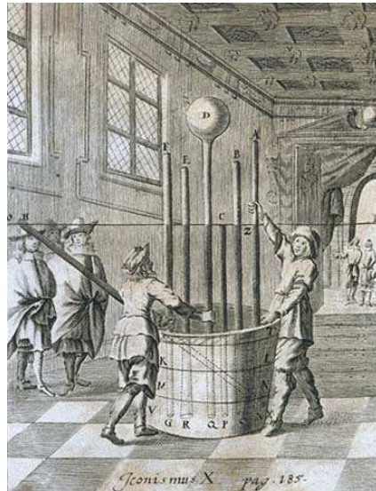
Figura 6: O nível de mercúrio é sempre o mesmo, independente do volume do tubo. Esta é mais uma evidência da pressão atmosférica.
