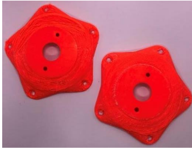
Figura 25 – Fotografias das peças impressas em duas configurações distintas: sem suporte (à esquerda) e com suporte, já destacado (à direita)
