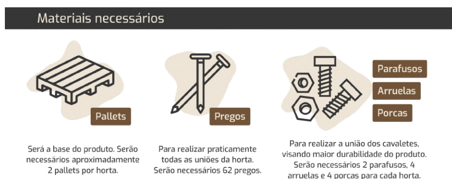
Figura 60 - Materiais necessários para a construção da horta.
