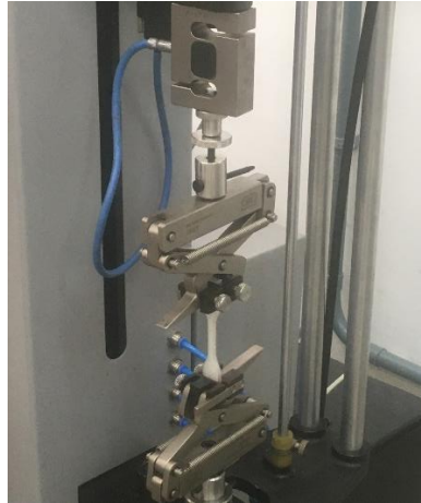
Figura 19 – Teste de tração realizado no Instituto Federal do Rio Grande do Sul.
