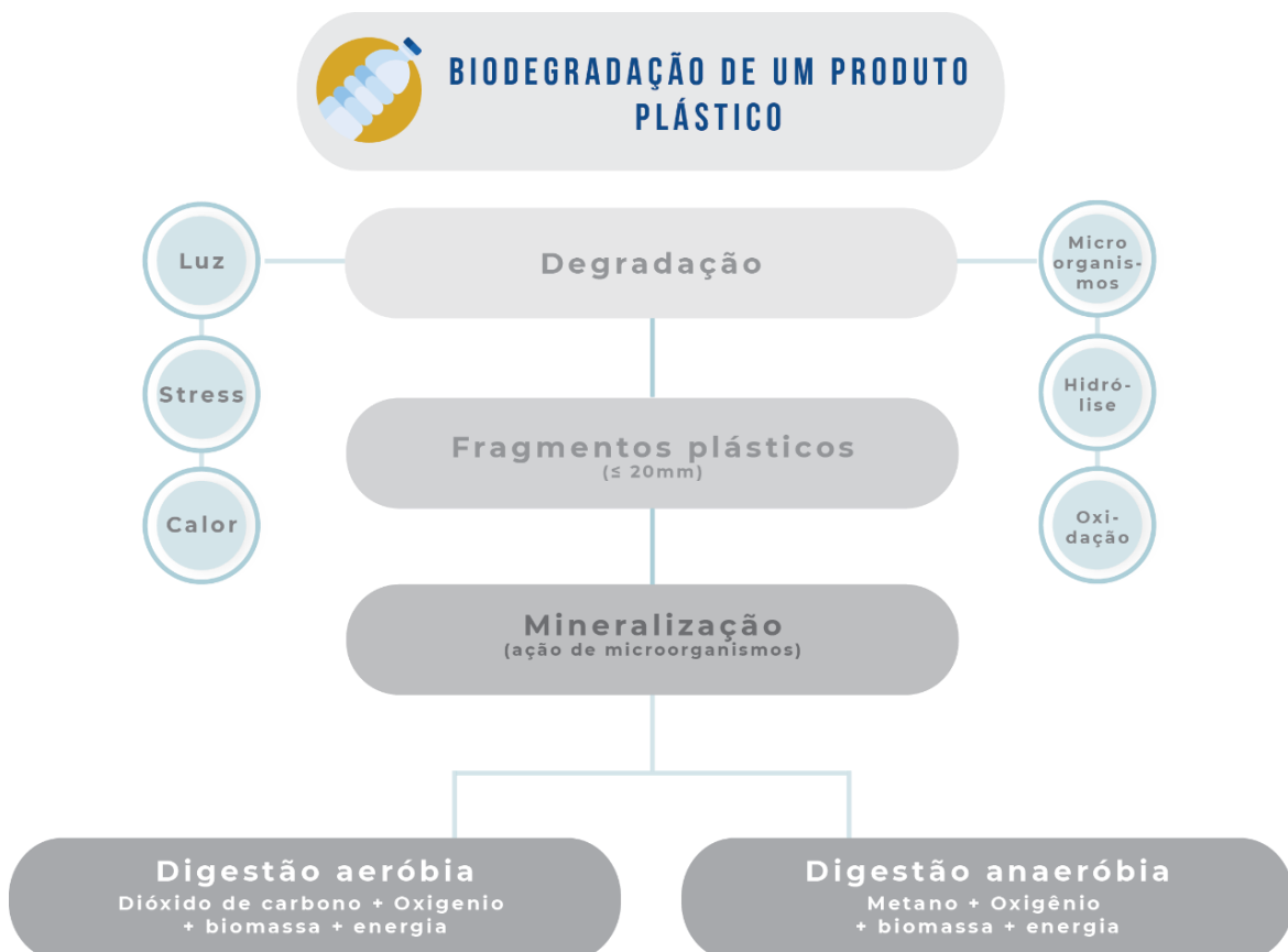
Figura 6 – Diagrama esquemático da biodegradação de um produto polimérico sólido, mostrando os dois estágios principais de degradação
