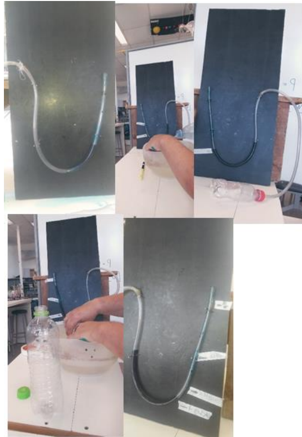
Figura 16: Medidas de temperatura e marcações feitas pelo estudante.
