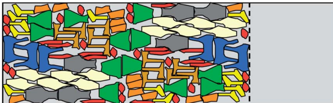
Figura 62: Encaixe de 96 moldes que compõem seis maiôs Fonte: Bennel e Oliveira (2008)
