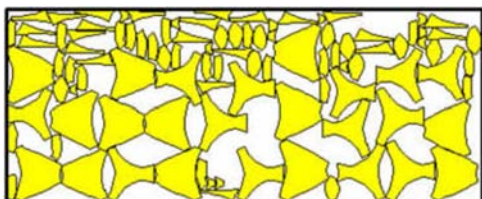
Figura 07: Encaixe dos moldes de um biquíni com eficiência de 56,85% Fonte: Wong et al. (2009)
