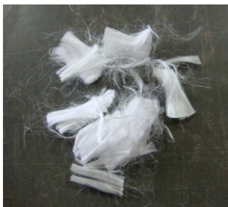
Figura 14: fibras de polipropileno utilizadas na pesquisa
