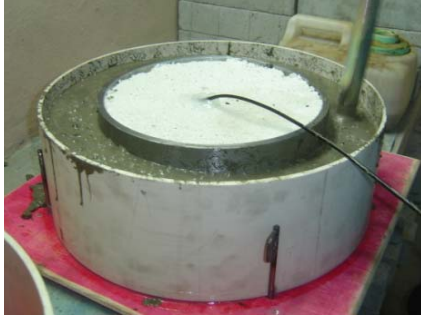
Figura 39: processo de concretagem dos CP's
