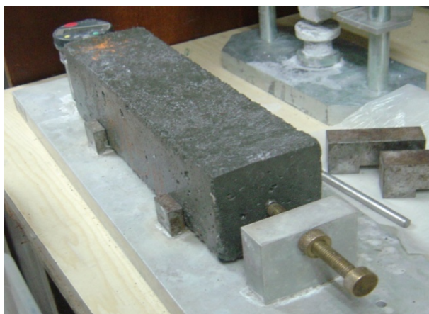
Figura 24: variação unidimensional - deformação referência (inicial)
