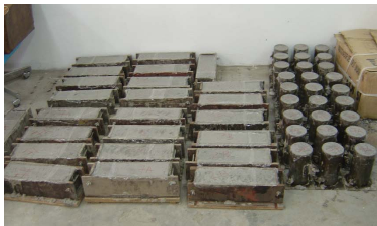
Figura 22: armazenamento dos corpos-de-prova após a moldagem
