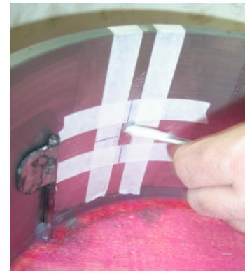
Figura 30: limpeza da superfície (exata) de colagem
