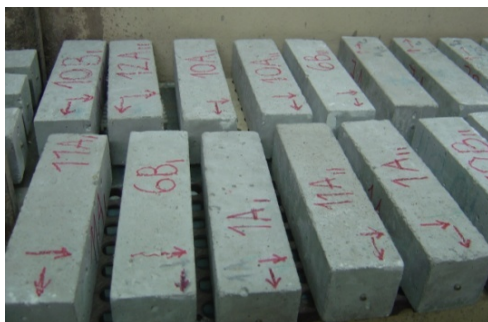
Figura 25: processo de secagem – câmara climatizada
