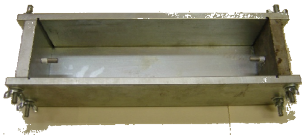
Figura 20: fôrma prismática de 7,5 x 7,5 x 28,5 cm
