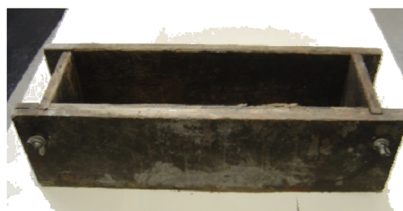
Figura 19: fôrma prismática de 10 x 10 x 35 cm
