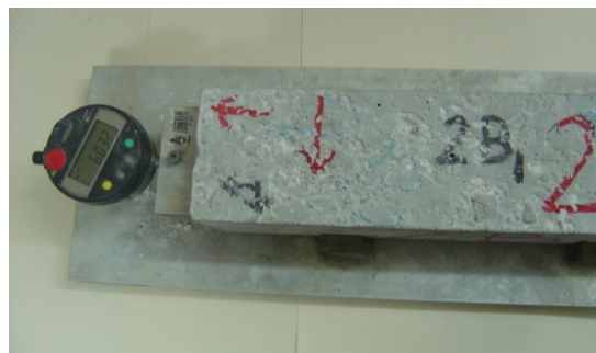
Figura 26: leitura da variação unidimensional (retração por secagem livre)
