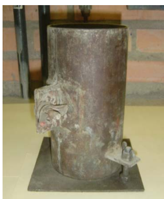
Figura 18: fôrma cilíndrica de 9,5 x 19 cm
