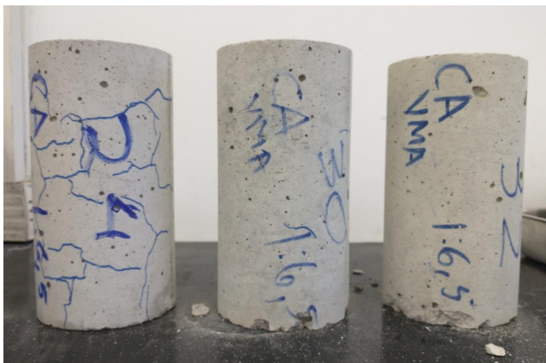
Figura 67: Fissuras CAA VMA 1:6,5
