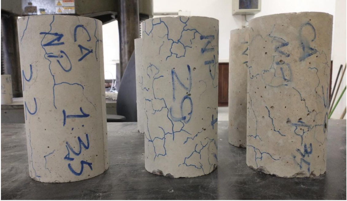
Figura 68: Fissuras CAA NP 1:3,5
