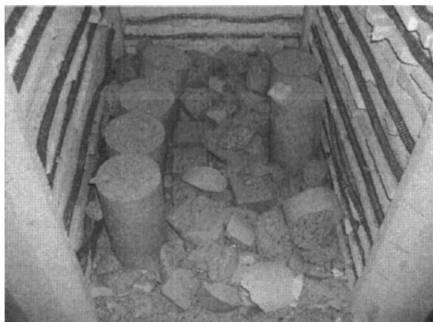
Figura 8: Corpos de prova de CC que sofreram spalling a 500°C
