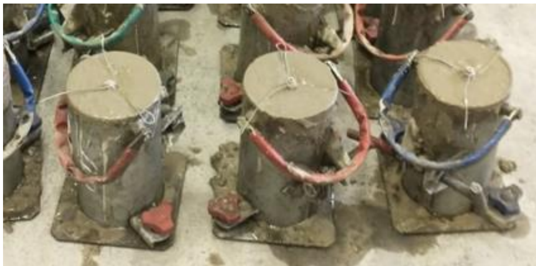
Figura 23: Concretagem de corpos de prova com tubos de cobre
