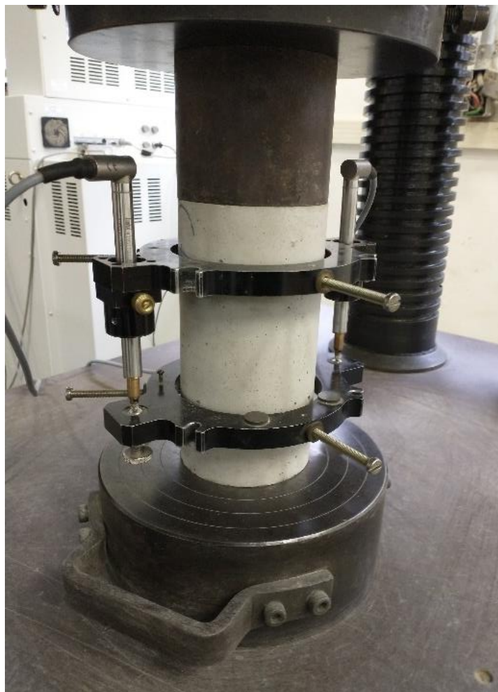
Figura 20: Ensaio do módulo estático de elasticidade
