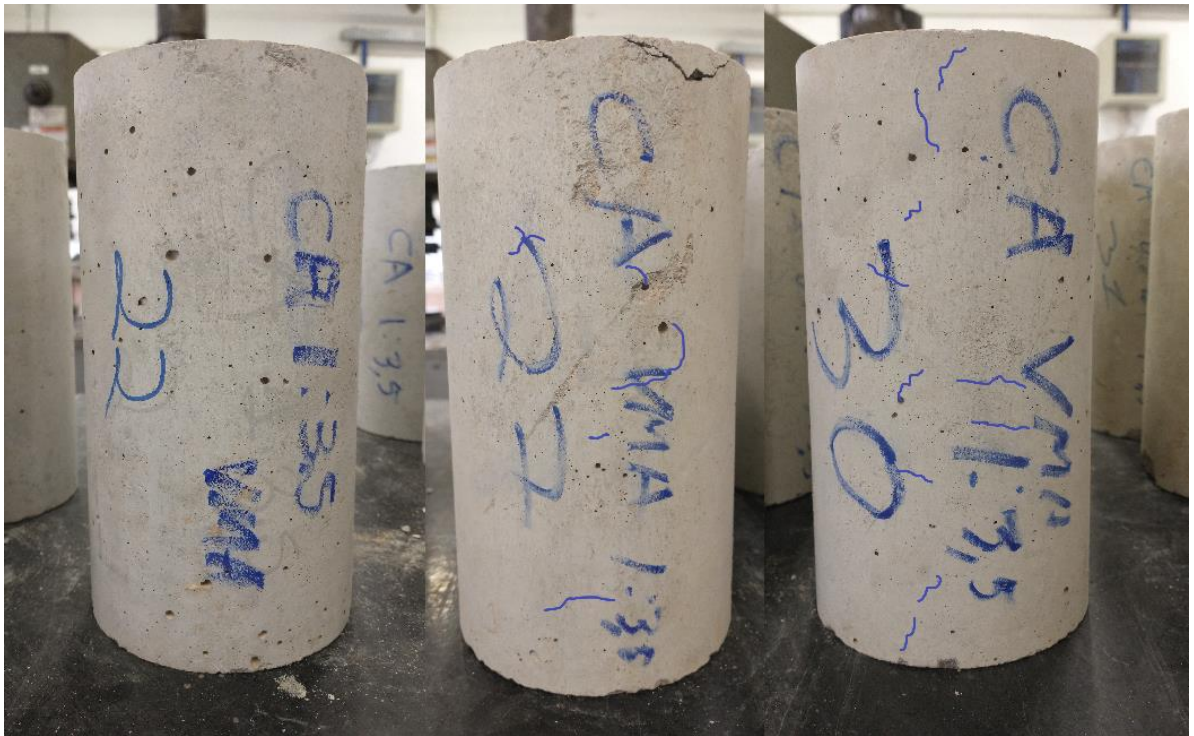
Figura 65: Fissuras CAA VMA 1:3,5
