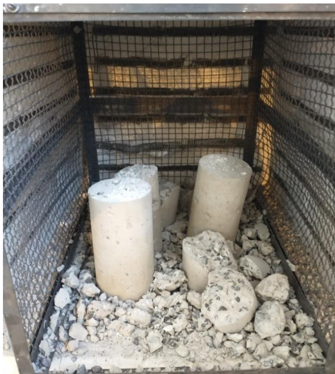
Figura 72: Corpos de prova após aquecimento/ spalling (CC e CAA VMA)
