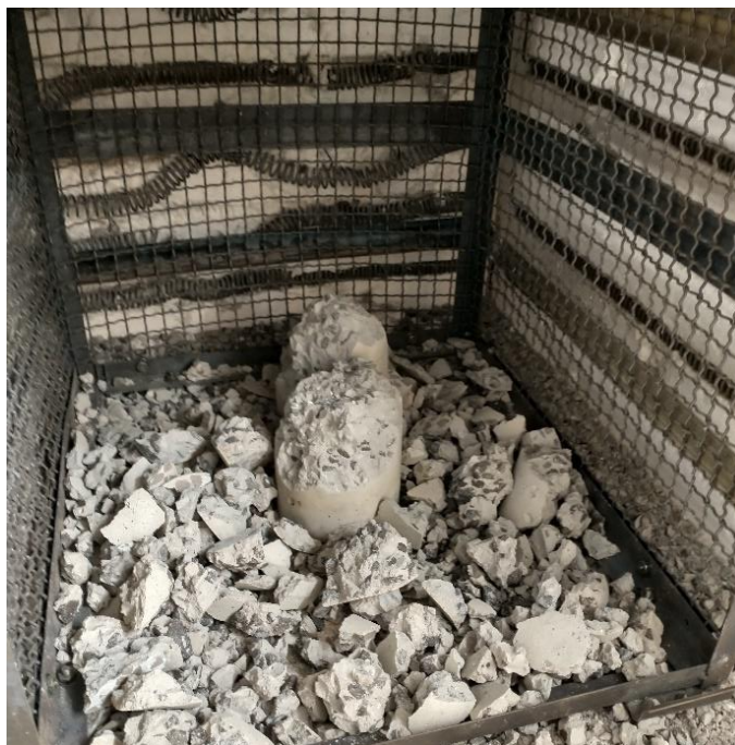
Figura 74: Corpos de prova após aquecimento/spalling (CAA NP)
