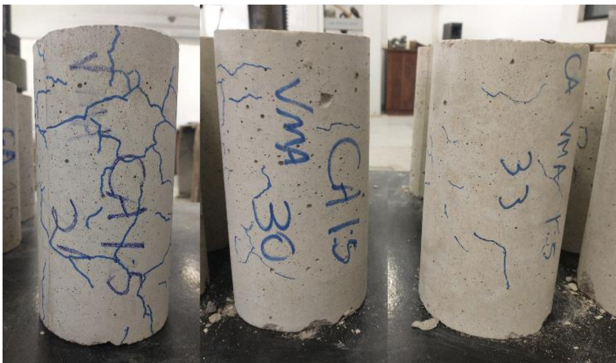
Figura 66: Fissuras CAA VMA 1:5
