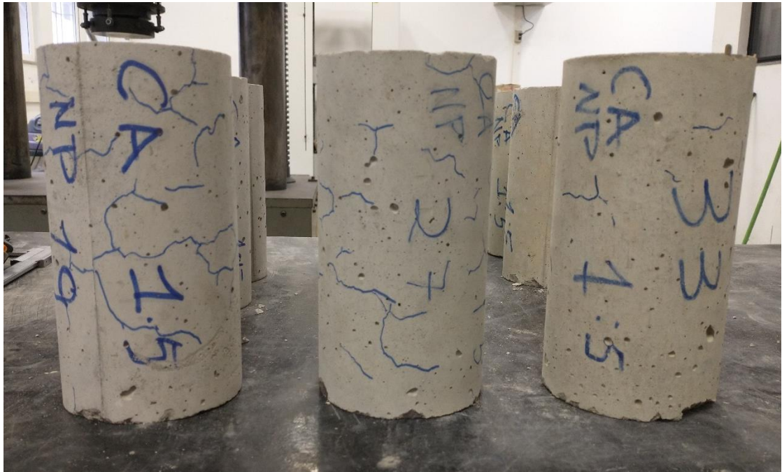
Figura 69: Fissuras CAA NP 1:5
