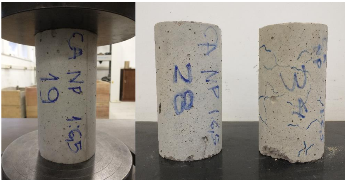
Figura 70: Fissuras CAA NP 1:6,5
