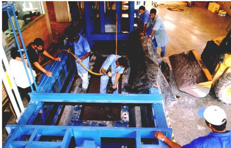
**FIGURA 5.27** Compactação das Extremidades do Maciço Experimental
