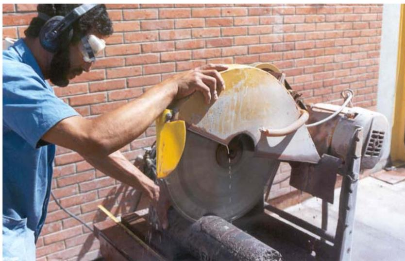
**FIGURA 5.14** Usinagem de Testemunhos para Obtenção de Corpos-de-prova
