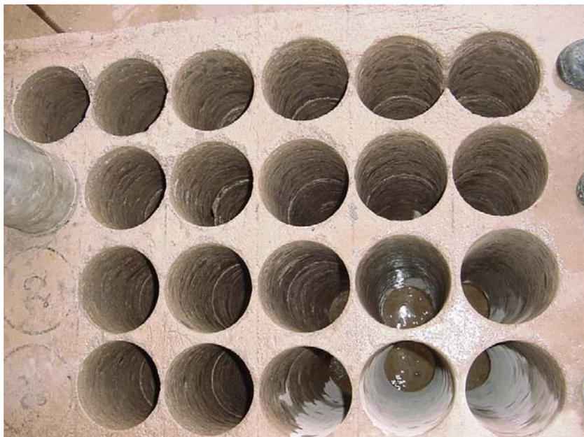
**FIGURA 5.10** Seqüência de Furos de Sondagem
