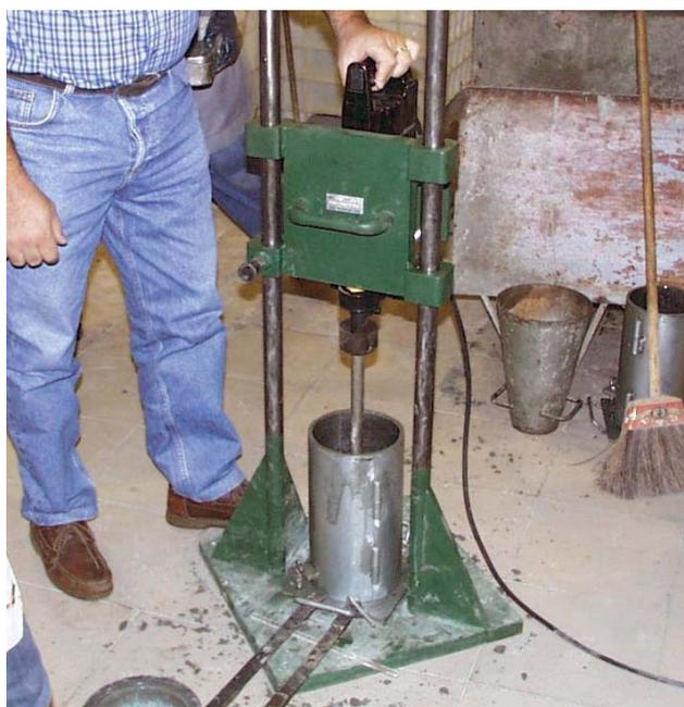
**FIGURA 3.18** Adensamento de Corpo-de-prova com Martetele Tipo Kango
