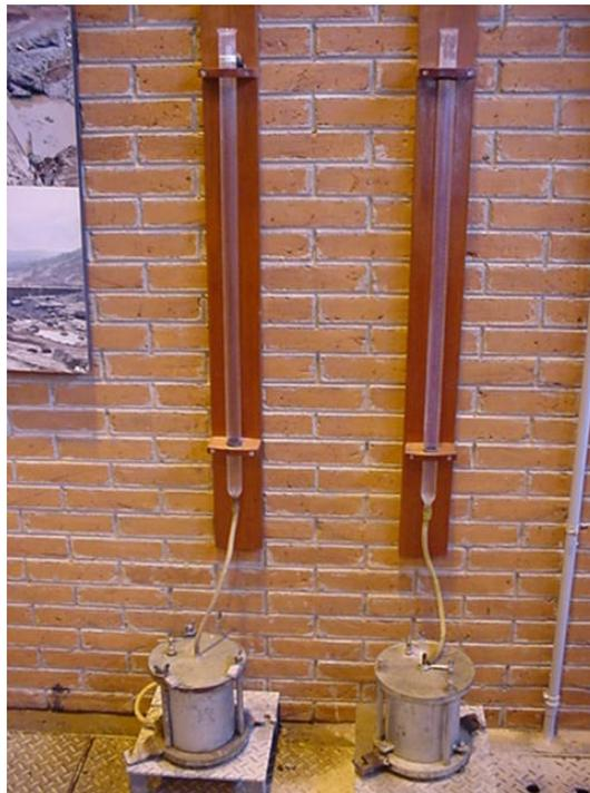
**FIGURA 2.21** Ensaio de Permeabilidade do Concreto Fresco
