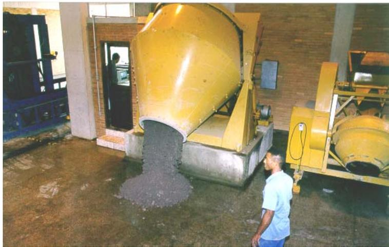
**FIGURA 5.24** Descarga Pós-mistura
