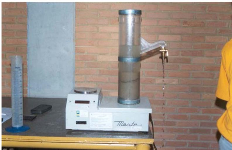
**FIGURA 2.22** Dispositivo para Medida do Teor de Água (DMA)
