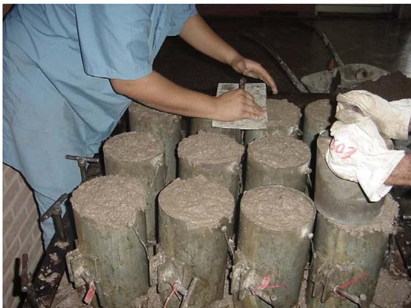
**FIGURA 3.19** Corpos-de-prova Adensados em Mesa Vibratória
