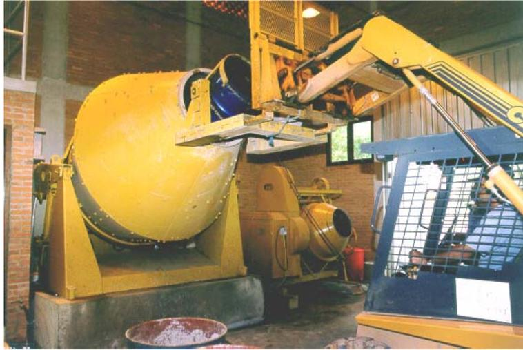
**FIGURA 5.23** Sala de Dosagem e Carregamento da Betoneira
