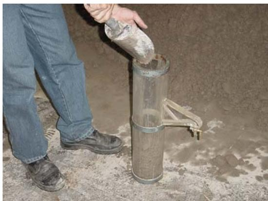
(a) Colocação de Amostra no DMA
