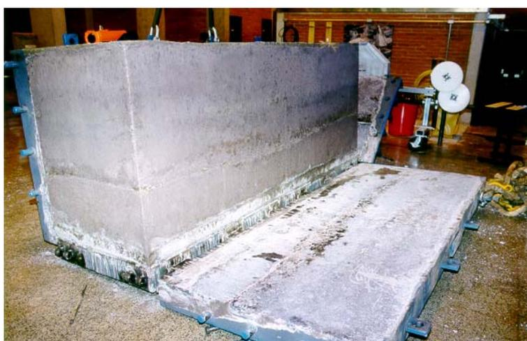
**FIGURA 5.32** Desforma da Maciço Experimental
