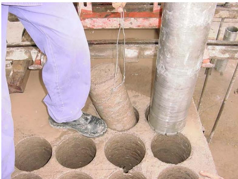
**FIGURA 5.11** Retirada do Testemunho do Furo
