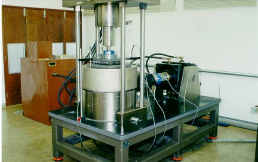
**FIGURA 3.15** Equipamento para Ensaio de Cisalhamento Direto
