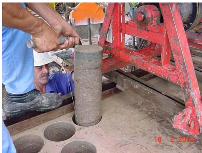
**FIGURA 5.37** Retirada de testemunho
