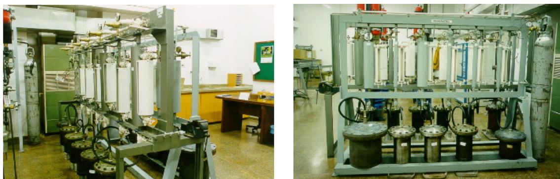
**FIGURA 3.1** Equipamento para Ensaios de Permeabilidade à Água
