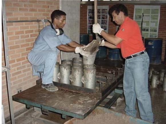
**FIGURA 2.19** Moldagem e Compactação em Mesa Vibratória de Corpos-de-prova de CCR
