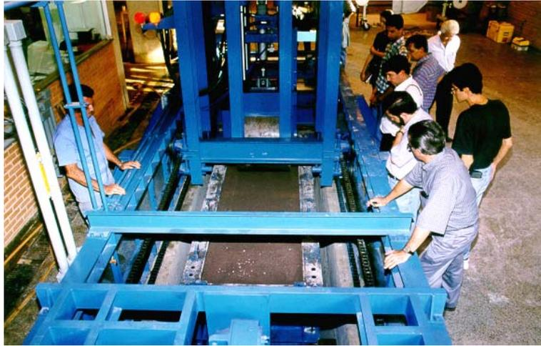
**FIGURA 5.29** Vista Geral do Equipamento no Início da Compactação
