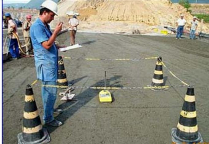
**FIGURA 3.21** Utilização do Densímetro Nuclear - UHE Lajeado
