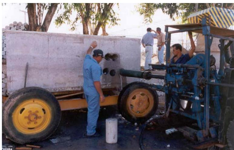
**FIGURA 5.12** Extração de Testemunhos na Posição Horizontal
