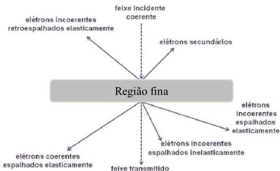
Figura 3.9: Espalhamentos do feixe de elétrons ao incidir na amostra 51 .
