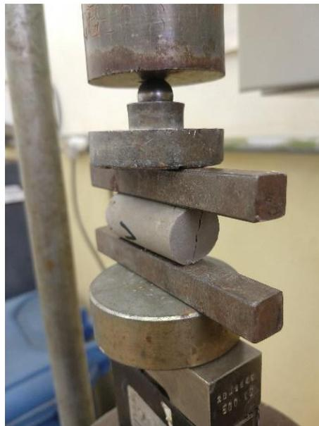
Figura 3.21 - Ensaio de compressão diametral das pastas.
