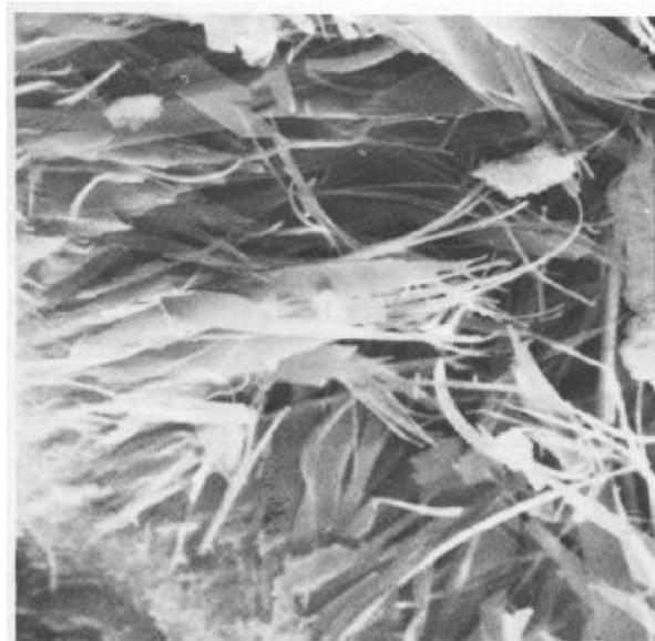
Figura 2.1 – Fotomicrografia da pasta de cimento Portland endurecida. Fonte: (INGLES; METCALF, 1972)
