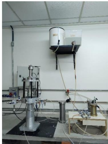
Figura 3.47 – Reservatórios de água acima da prensa triaxial.
