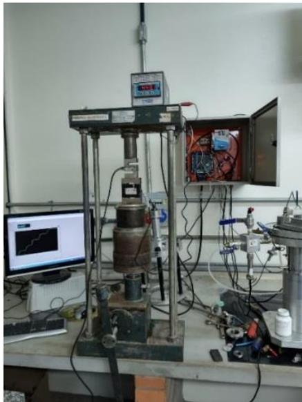
Figura 3.44 - Calibração da célula de carga.
