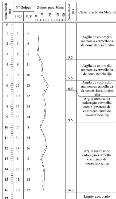
Figura 2.28 – Ensaio de sondagem a percussão do solo do campo experimental com circulação de água. Fonte: Junior e Thomé (2005).
