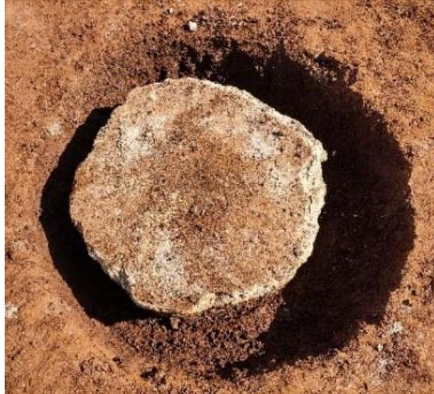
Figura 3.31 - Retirada lateral do solo da camada cimentada.
