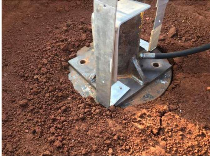
Figura 2.17 – Puncionamento de uma placa metálica após o ensaio de placa sobre solo residual (MOREIRA, 2020).
