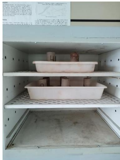
Figura 3.42 - Corpos de prova na estufa.
