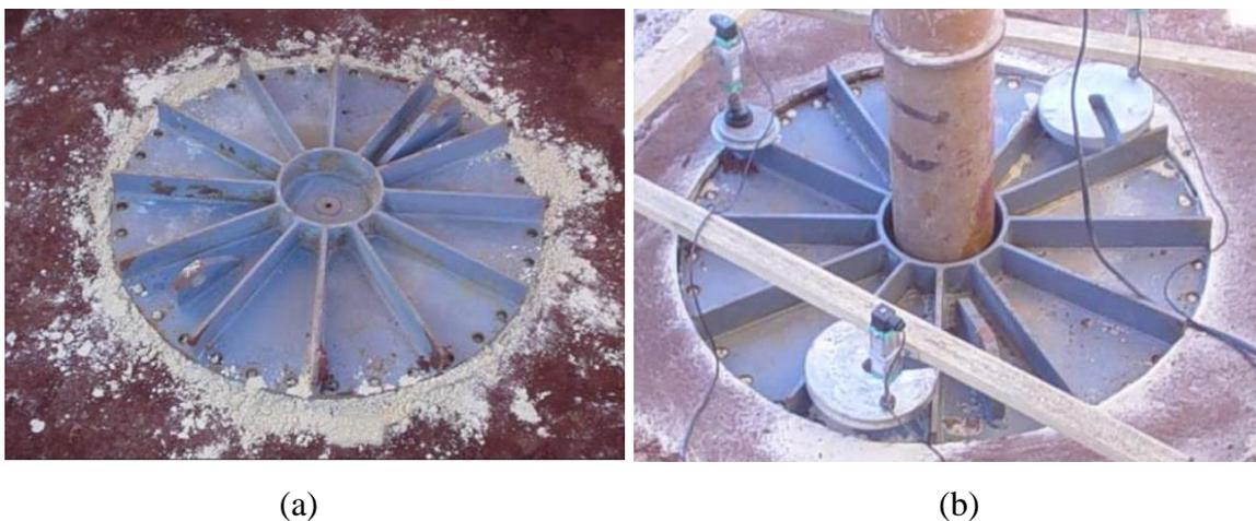
Figura 2.31 – Ensaio de placa sobre o solo do campo experimental: (a) Instalação da placa com uma camada de areia, (b) Ruptura por puncionamento do solo.
