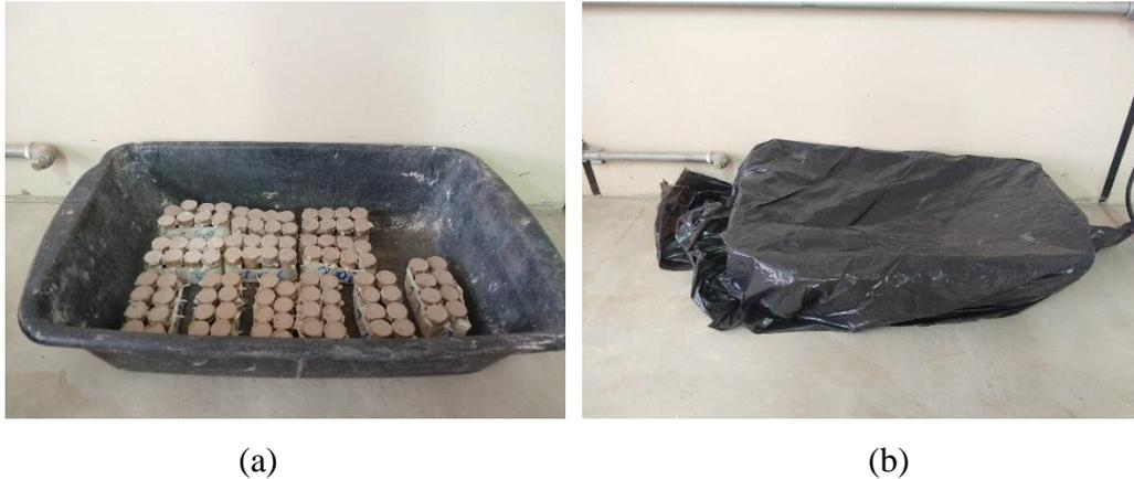
Figura 3.18 - Cura dos corpos de prova da etapa de pré-dosagem: (a) acomodação dos moldes; (b) fechamento do local.
