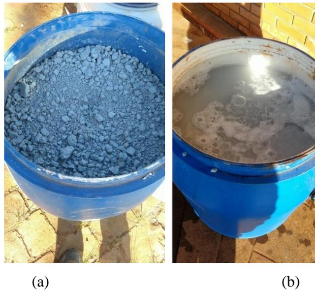
Figura 3.12 - Armazenamento da cal de carbureto: (a) seco; (b) coberto de água.
