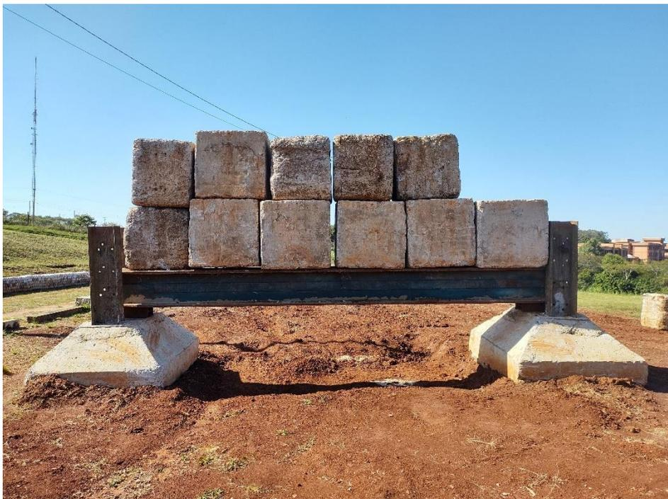
Figura 3.32 - Pórtico de reação.
