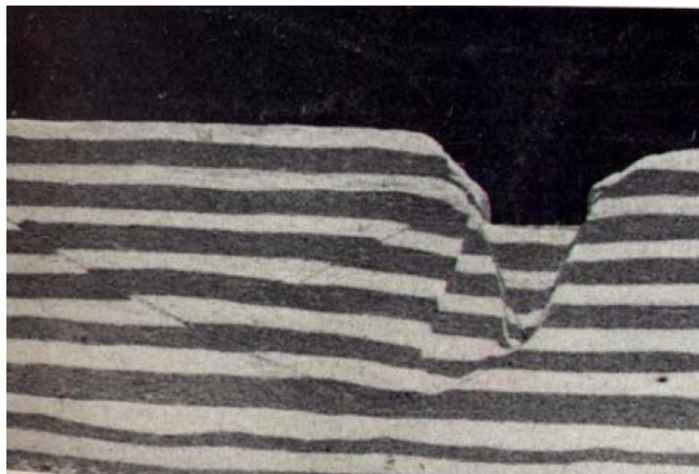
Figura 2.15 - Padrão de ruptura generalizada sob sapata retangular sobre areia compacta ( $D_r = 100\%$ ). (DE BEER; VESIC, 1958)
