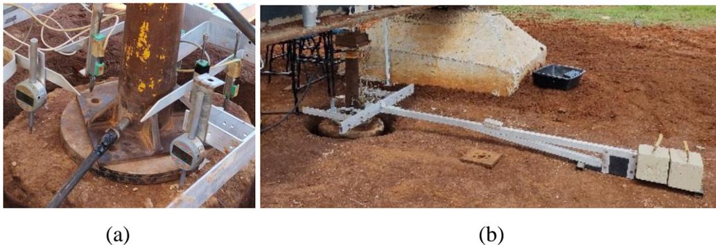
Figura 3.35 - Sistema em campo: (a) medidores de deslocamento; (b) viga de suporte.
