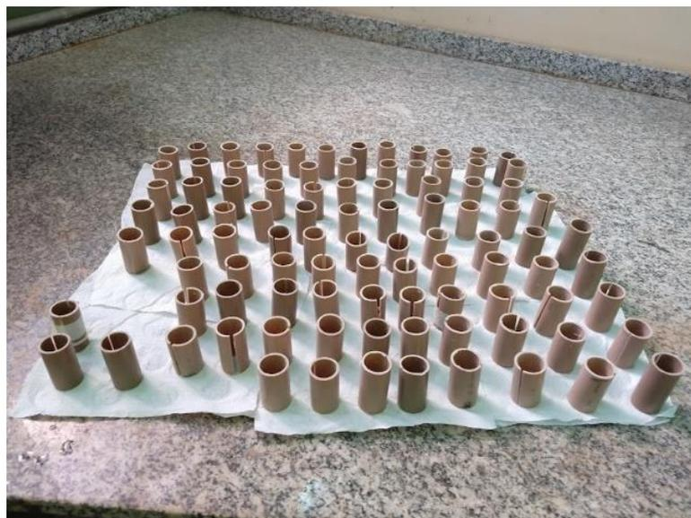
Figura 3.16 - Moldes dos corpos de prova da pré-dosagem.
