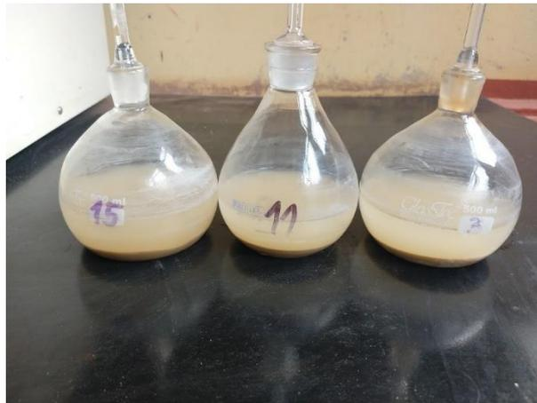
Figura 3.4 - Massa específica da areia de Osório.
