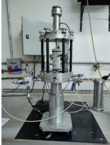
Figura 3.43 - Prensa triaxial do Laboratório de Geotecnia da Universidade de Passo Fundo.
