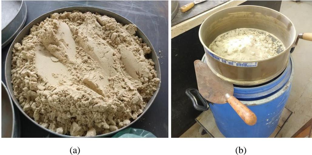
Figura 3.2 – Tratamento da areia de Osório: (a) Secagem; (b) Peneiramento da areia de Osório.
