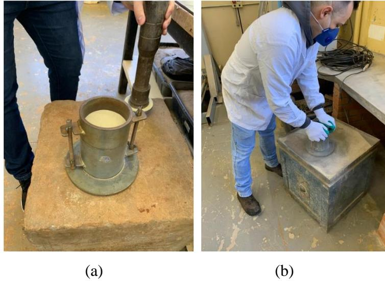
Figura 3.5 - Índice de vazios mínimo da areia de Osório: (a) compactação; (b) uso da mesa vibratória.
