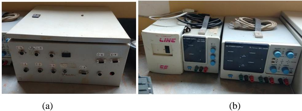
Figura 3.34 - Sistema de aquisição de dados: (a) placa de aquisição; (b) fonte de alimentação e nobreak.
