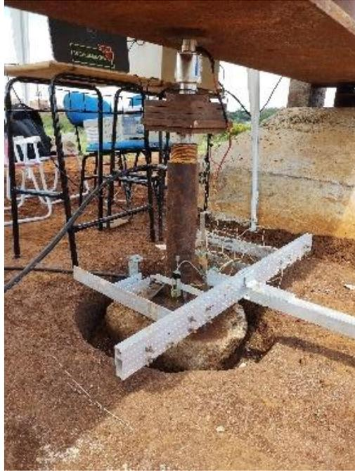
Figura 3.36 - Sistema completo do ensaio de placa.
