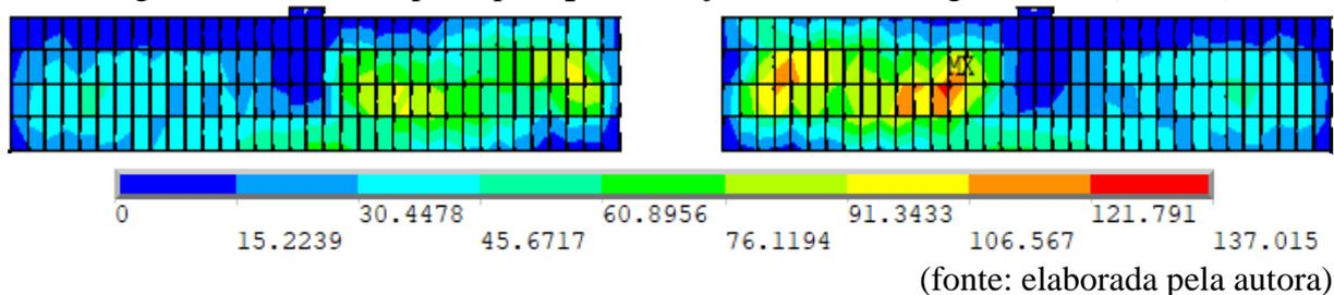
Figura 6.22 – Tensões de aderência na interface da viga B-CW2 (kN/cm<sup>2</sup>)
