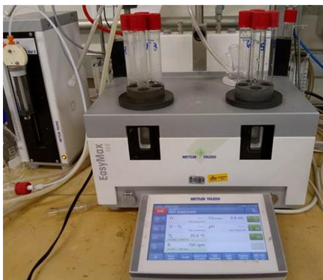
Figura 17: Imagem do reator Easy Max 102 utilizado para os testes de polimerização.
