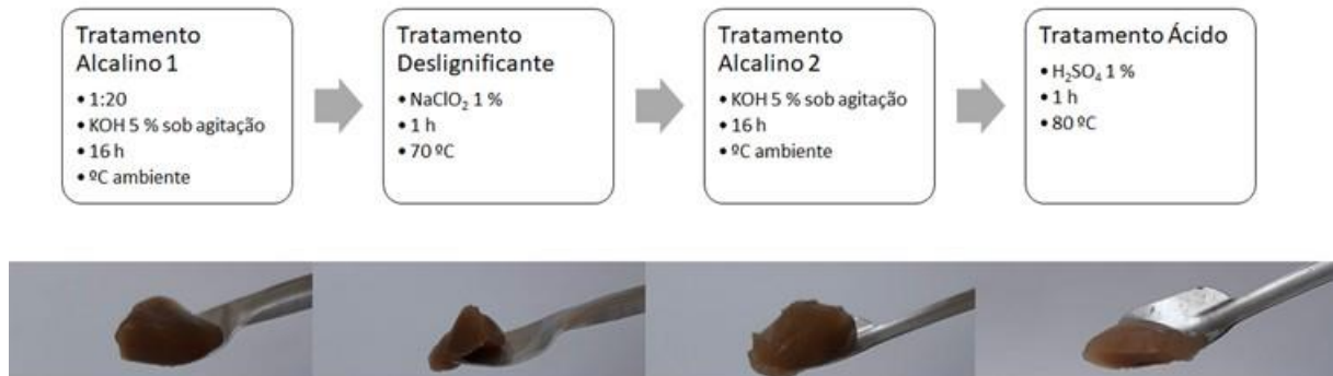
Figura 6 - Fluxograma para obtenção da nanofibras de celulose pelo tratamento químico
