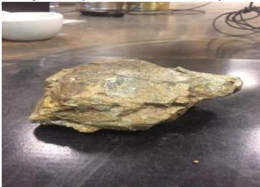
Figura 2– Maciço sulfetado de cobre contendo calcopirita.
