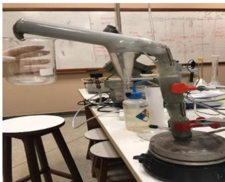
Fonte: REGO, Oséias Costa. Flotação sendo realizada no tubo de Hallimond modificado. 2020
