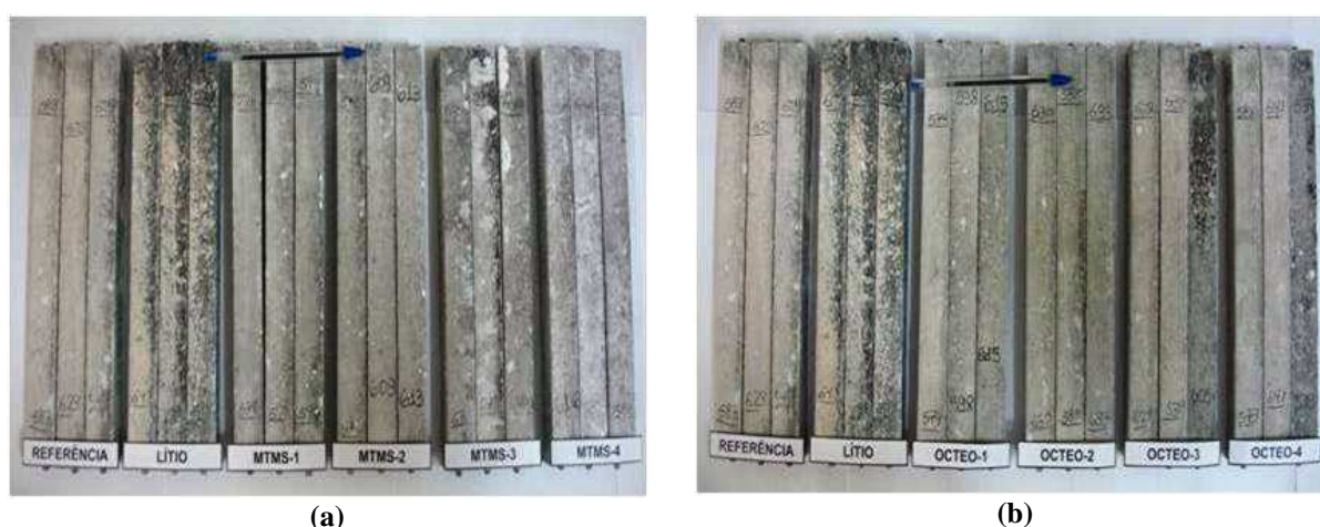
Figura 68: Aspecto final das barras pós-tratamento, aplicação múltipla. (a) Barras tratadas com MTMS; (b) Barras tratadas com OCTEO
