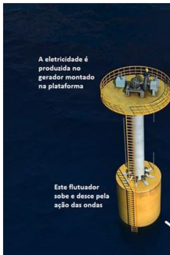
Figura 2.22 – Funcionamento do dispositivo [Planeta COPPE, 2015].
