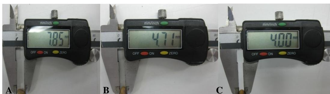
APÊNDICE 2. Biometria com paquímetro digital demonstrando A) comprimento, B) largura e C) espessura das sementes de *Sesbania punicea*.
